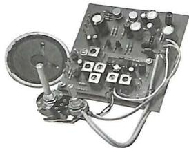
tamente, già schermate e a poco prezzo, tutte le bobine che servono: vanno bene tutti i tipi di trasformatore, indipendentemente dal calore del nucleo (rosa, verde, arancio). I varicap più idonei sono i doppi BB204, anche se la foratura dello stampato (Figura 6; disposizione dei componenti in Figura 7) consente la facile installazione di modelli diversi. Con i BB204, si potrà spaziare con la sintonia tra i 6,5 e i 16 MHz circa.
