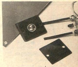
Fig. 4. Si scorge il riflettore del diodo emettitore.
