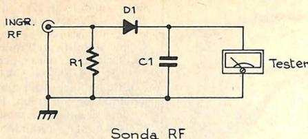
Figura 4. Schema elettrico della sonda.
