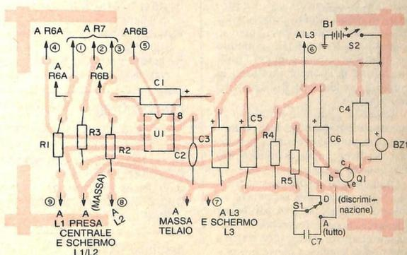
Figura 3. Schema di montaggio dei componenti.
