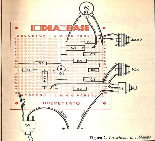
Figura 2. Lo schema di cablaggio.
