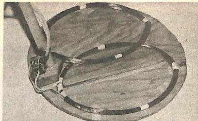
Foto 2. Questo primo piano della testa di ricerca mostra la posizione delle bobine  $L_1$ ,  $L_2$  e  $L_3$  e le loro rispettive sovrapposizioni.
