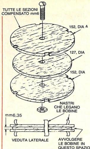
**Figura 5.** Usate questa dima per avvolgere le bobine. Le bobine ultimate saranno circolari, e el dovrete piegare dando loro forma ovale, come si vede nel disegno qui sopra, per installarle.
