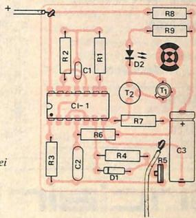
**Figura 5.** Circuito stampato del ricevitore.
