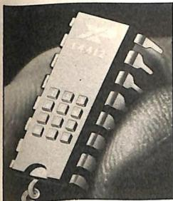
con tensione da 4,75 a 15 V. e da 4,75 a 6 V. Il modem interessa i mercati delle telecomunicazioni e delle periferiche di computer, può essere usato nei modem standard, terminali remoti, accoppiatori acustici e modem costruiti nell'interno di terminali, e anche per ridurre la misura delle piastre stampate dato che contiene in un chip il modulatore e il demodulatore.
