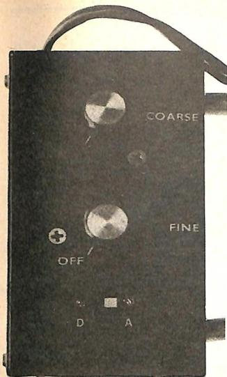
Foto 3. La testa di comando del trova-metalli è di disegno semplice: comprende un commutatore e due manopole di regolazione.
