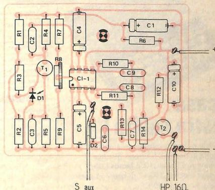
**Figura 6.** Schema di montaggio dei componenti.
