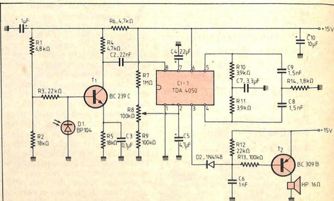
Figura 2. Schema elettrico del ricevitore.
