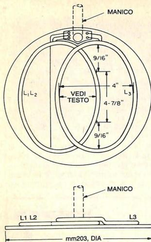
**Figura 4.** L'indicazione per le quote per la testa di ricerca mostra come piegare le bobine dando loro la forma ellittica necessaria per l'installazione sulla base in compensato della testa di ricerca.
