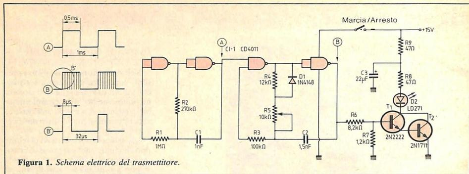
Figura 1. Schema elettrico del trasmettitore.
