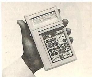
Le EPROM si estendono da 8 a 128 Kbyte, mentre le RAM autoalimentate opzionali vanno da 2 a 16 Kbyte e possono essere trasferite anche per posta, grazie alla loro autonomia. La presenza della porta RS-232 consente l'invio di dati via modem o via cavo.
