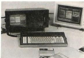
e 1 parallela Centronics; sistema operativo CP/M 2.2. Dimensioni: 38 per 46 per 20 cm; peso: 13 kg. Il software compreso nel prezzo del Kaypro 10 e del 2X include: The Word Plus, dBase II con programma d'apprendimento, InfoStar, MailMerge,
