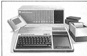
L'Home Computer TI-99/4A si può collegare ad un normale apparecchio televisivo e può espandersi fino a diventare un sistema computerizzato completo con l'aggiunta di unità periferiche come ad esempio due normali registratori a cassetta, unità di controllo a distanza, memorie a disco, sintetizzatore della voce e stampante termica.
