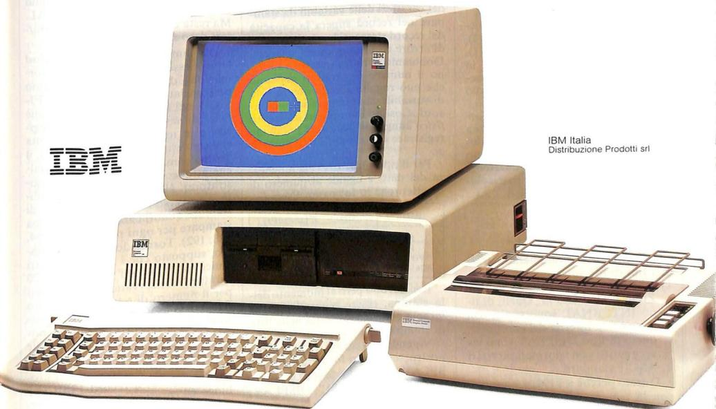
Il Personal Computer IBM contiene un microprocessore a 16 bit e una memoria di utilizzo che raggiunge i 640 Kbyte, e può essere dotato di un video a colori e di un processore matematico. E, grazie ai dischi fissi, la capacità massima di memoria del sistema è di 21 Mbyte in linea. Inoltre, puoi facilmente collegarti con un altro Personal Computer IBM, con elaboratori più potenti e con la rete dei Centri Servizi Elaborazione Dati della IBM.
