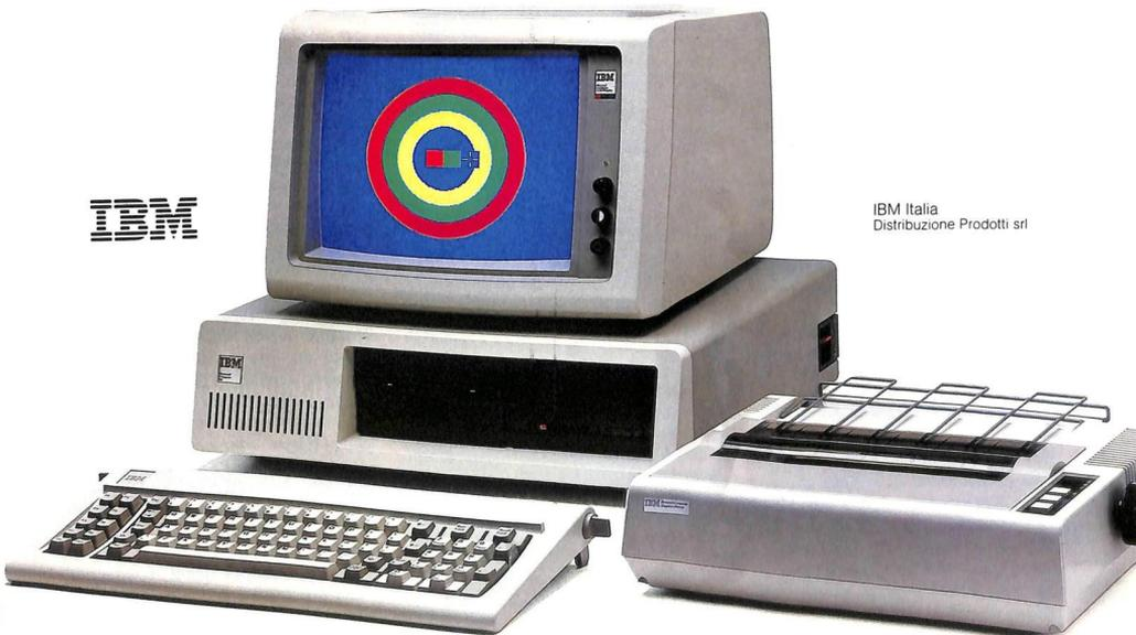
Il Personal Computer IBM contiene un microprocessore a 16 bit e una memoria di utilizzo che raggiunge i 640 Kbyte, e può essere dotato di un video a colori e di un processore matematico. E, grazie ai dischi fissi, la capacità massima di memoria del sistema è di 21 Mbyte in linea. Inoltre, puoi facilmente collegarti con un altro Personal Computer IBM, con elaboratori più potenti e con la rete dei Centri Servizi Elaborazione Dati della IBM.
