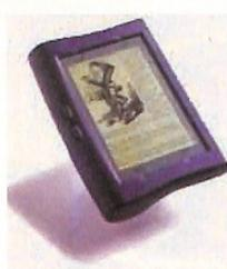
essere espansi fino a 32 Mb. Il display è di 4,5 per 3 pollici, con risoluzione di 480x320 pixel in bianco e nero retroilluminato. Il peso è di 627 grammi. Può eseguire file WAV ed ha una porta seriale affiancata da una porta a infrarossi. L'autonomia, dichiarata dalla casa costruttrice, è di 20 ore con la retroilluminazione, e di 40 ore senza retroilluminazione.
