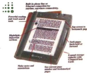
ria su CompactFlash Card, un display da 6x8 pollici in tonalità di grigio, retroilluminato e sensibile al tatto. La batteria agli ioni di litio ha un'autonomia dalle 2 alle 5 ore e il peso del Reader è di 1,3 kg.
