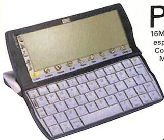
**P**rocessore ARM 710T da 32bit a 36 MHz e 16Mb di RAM espandibile con Compact Flash Memory Card. Sistema operativo EPOC è nella ROM da 10Mb. Schermo LCD Touch Screen
