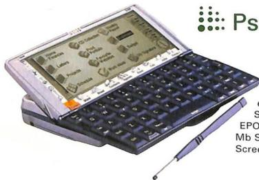
**P**rocessore: ARM 710T da 32bit a 36 MHz con 8Mb di memoria non espandibile. Sistema operativo EPOC nella ROM da 8 Mb Schermo LCD Touch Screen con risoluzione
