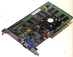
della GPU a 200MHz, la memoria DDR a 166MHz, la capacità di calcolo fino a 1600 milioni di texel al secondo, 25 milioni di triangoli al secondo. La massima risoluzione arriva a 2048x1536 a 16.7 milioni di colori a 60Hz.
