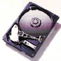
velocità di rotazione 7200 RPM, ed un tempo di accesso medio di accesso di appena 8.5 ms. Il buffer interno è di 2 MB. Compatibile con lo standard ATA 66+ e incorpora tutte le più recenti soluzioni tecnologiche, come la IBM safety ramp, che protegge i dischi dal movimento accidentale delle testine in fase di installazione e durante le operazioni di spegnimento.
