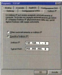
Figura 1: Configurazione dell'indirizzo di rete sotto Win 95/98.
