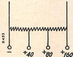
Ma se chiediamo la tensione necessaria alla rete, la cosa è ben diversa. Fra i due estremi del circuito in cui circola la corrente raddrizzata, si trova la tensione massima fornita dal dispositivo: il problema consiste nel prendere ogni tensione utile fra lo zero e il + massimo.
