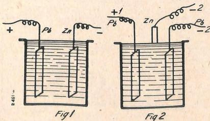
L'elettrodo + è una lamiera di piombo ossidata (placca + di accumulatore) e l'elettrodo — una lamina di zinco. Il tutto immerso in una soluzione acidulata, che forma l'elettrolito. Perché funzioni, occorre che la lamina sia carica, e questo si può ottenere togliendo provvisoriamente l'elettrodo di zinco e sostituendolo con un'altra lamina di piombo.
