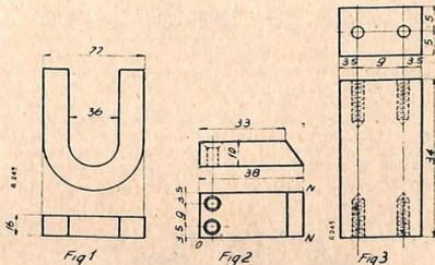
di diametro fresati superiormente. Il lato M. N. dovrà essere perfettamente perpendicolare al lato O. O.
