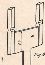
8) Tagliamo ancora un pezzo di filo di rame quadrangolare, della lunghezza di 55 mm. perfettamente teso; su di esso faremo due tacche sopra e sotto come quelle già praticate nei due pezzi di filo precedenti, ma questa volta a 5 mm. da una delle estremità; sal-
