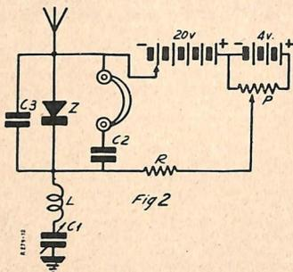
La zincite ottenuta con questi metodi è di colore giallo. Avendo a disposizione un certo numero di cristalli di zincite se ne scieglierà quello che possiede la maggiore conducibilità; ciò si può verificare a mezzo di un milliamperometro e d'una piccola batteria (4 Volt).
