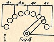
La resistenza R in serie col potenziometro ha un valore di 1500 ohm, ed è costituita da un filo di costantana del diametro di 0,1 mm. isolato in cotone o seta, della resistenza di circa 12 ohm per metro, avvolto su di una bobinetta di fibra o legno secco.
