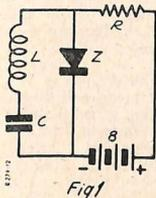
di chiudersi attraverso alla batteria B, dalla resistenza induttiva R.
