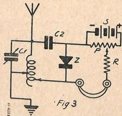
La sorgente d'energia elettrica (S) necessaria al funzionamento in generatore della zincite è costituita da una batteria di pile da lampada tascabile, di una ventina di Volt il cui polo negativo è direttamente collegato alla punta di acciaio del detector. Solo in casi rarissimi si è costretti ad usare una tensione superiore (30:35 Volt come massimo). Questa tensione è variabile secondo i cristalli di zincite; perciò è bene prelevare la tensione di 4 in 4 Volt.
