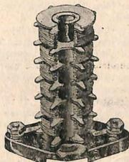
Fig. 3 - Resistenza metallica.
