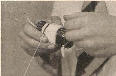
primario alla terra; entrata del secondario alla massa, od al filamento, nel caso dell'apparecchio in continua; uscita del secondario alla griglia od al condensatore di griglia, nel caso della rivelazione a caratteristica di griglia; entrata della reazione alla placca della rivelatrice; uscita della reazione alle placche fisse del condensatore di reazione. Nel caso che l'u-
