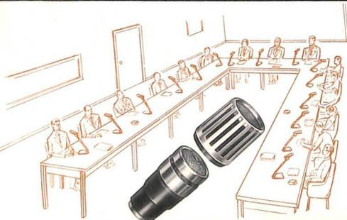
**NOTA: I MICROFONI A MEDIA IMPEDENZA (150-250 ohm) sono adatti per qualsiasi lunghezza di linea. Si possono collegare direttamente a miscelatori od amplificatori aventi ingressi a bassa impedenza. Se gli ingressi sono ad alta impedenza, interporre il**
