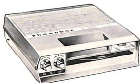
G 6/92 - Giradischi automatico, a transistori - 2 velocità: 33 e 45 giri/min. - Suona dischi diametro cm. 17,5 (con foro grande o piccolo), semplicemente inserendoli nella fessura - Arresto automatico a fine disco - Controlli di volume e di tono - Pulsante per la espulsione del disco in qualsiasi momento - Funziona in tutte le posizioni - Elevata potenza sonora - Alimentazione con 6 pile da 1,5 volt oppure (con alimentatore accessorio N. 2/1) con tensione di rete 110÷220 V - Dim. cm 26 x 27 x 8.
