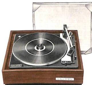
**G 1/307** - Giradischi semiautomatico stereo per Alta fedeltà, in mobile lucidato, con coperchio trasparente antipolvere. 4 velocità. Funzionamento automatico oppure manuale, con leva comando braccio agente su dispositivo idraulico. Dispositivo « anti-skating » regolabile. Fornito senza testina, per consentire il montaggio di testina magnetica, ceramica oppure ad alta impedenza. Dimensioni cm. 38 x 35 x 21.
