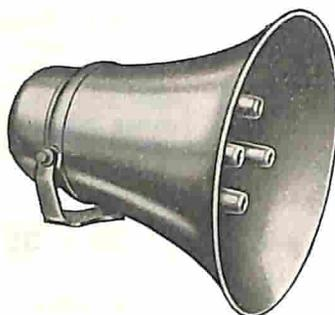
**N. 2578/A** - Tromba esponenziale costituita dal diffusore a giglio N. 2557 in materiale metallico e da 4 unità N. 2567 collegabili in parallelo per una impedenza complessiva di 4 ohm. Per lunghe linee usare il trasformatore di linea N. 2562, incorporabile nella tromba.
