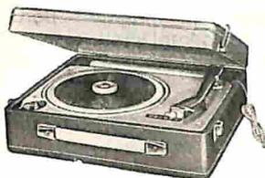
**N. 3021 - Complesso fono a 4 velocità, con pick-up piezoelettrico, montato in valigetta, alimentabile con tensione continua 9 volt o, facoltativamente, con tensione alternata di rete da 110 a 220 volt, 50 periodi.** E' montato in una valigetta elegante e solida, ricoperta di materia plastica, con maniglia retrattile. Richiede l'uso di 6 pile di 1,5 volt collegate in serie (ognuna diam. 33 mm, lunghezza 60 mm). Dimensioni cm 31 x 28 x 12. Peso netto circa kg 3,700.
