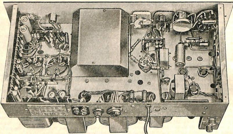
G 222-TR - Vista delle prese posteriori e degli organi e collegamenti posti sotto al telaio. Sono visibili: la morsetteria per l'attacco del tasto telegrafico (alle viti 1-2) e del circuito di comando «stand-by» (alle viti 3-4); il fusibile (tarato 3 A); il cambio tensioni; la vite per l'attacco della presa di terra; e a destra gli attacchi per l'antenna.
