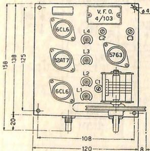
Dati d'ingombro e disposizione delle valvole, delle induttanze e delle viti di regolazione del Gruppo pilota N. 4/103/S.
