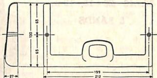
Dati di ingombro e di fissaggio, Serie 1640.
