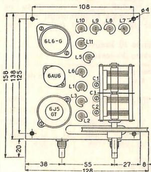
Dati d'ingombro e disposizione delle valvole e delle viti di regolazione del gruppo pilota N. 4/102/V.
