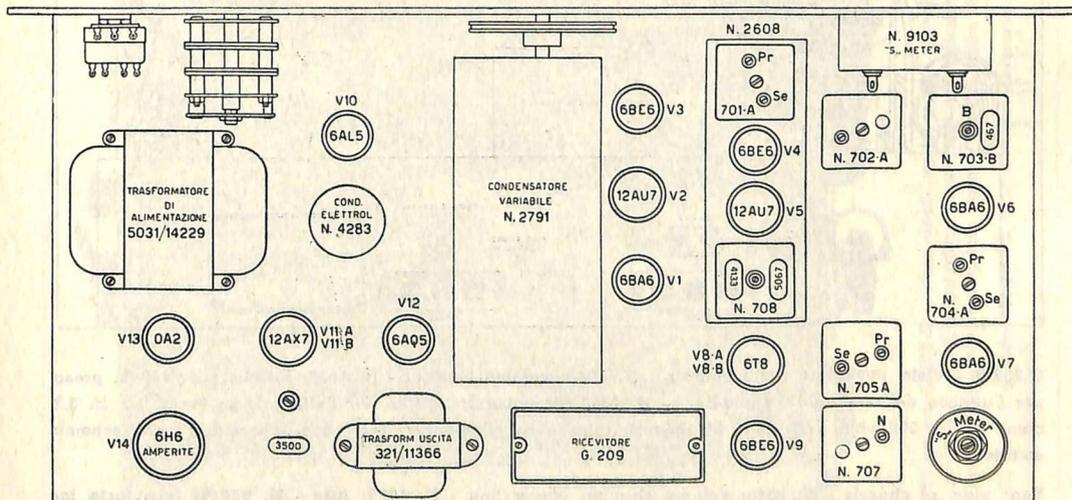
G 209-R - Posizione sullo chassis delle valvole, degli altri componenti e delle viti di regolazione.
