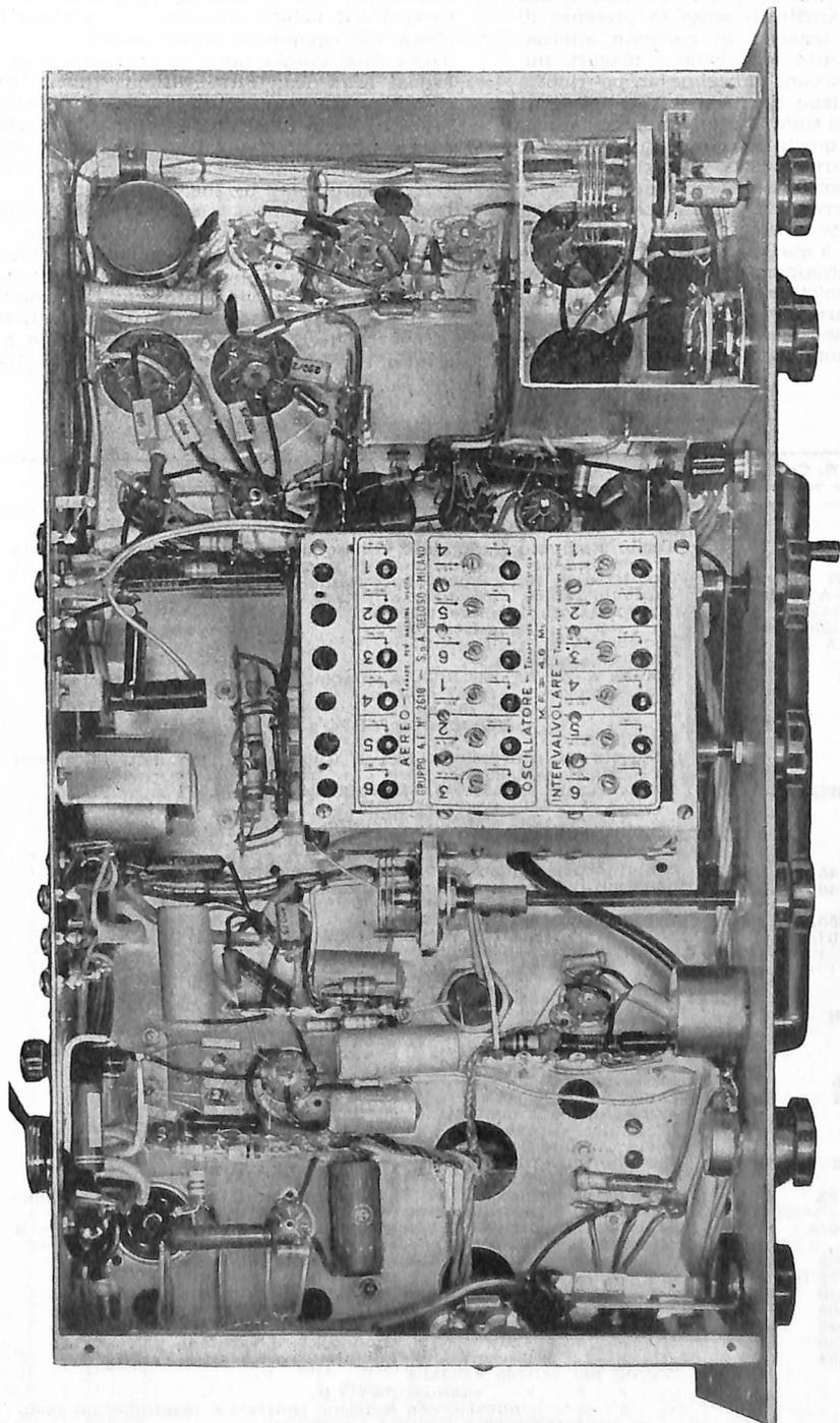
Ricevitore G 209-R - Vista degli organi e dei collegamenti posti all'interno del relciao. Il Gruppo RF è munito di una targhetta sulla quale le diverse viti di regolazione sono indicate mediante il numero d'ordine della banda e il valore della frequenza sul quale il circuito rispettivo deve essere regolato (mentre l'indice della scala indica quel dato valore stesso).
