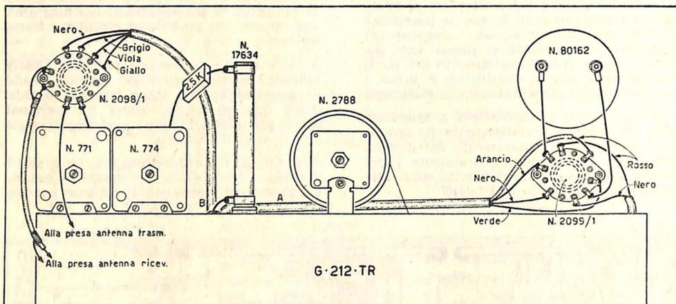
Il telaio del pilota VFO dovrà essere fissato al suo posto per ultimo, e così pure si dica per la scala di sintonia. Queste parti dovranno essere trattate con particolare riguardo; ogni loro manomissione o deformazione può causare deterioramenti o difetti di taratura.
