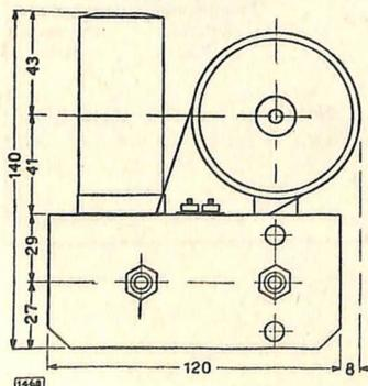
Dati d'ingombro e disposizione delle valvole e delle viti di regolazione del gruppo pilota N. 4/102.
