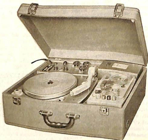
Questo apparecchio non solo consente la riproduzione microfónica diretta, la riproduzione fonografica e quella da nastro magnetico con possibilità di miscelazione: consente anche la registrazione magnetica su nastro e pertanto permette la riproduzione di ciò che può essere stato preventivamente registrato con lo stesso magnetofono; possibilità, questa, avente molteplici interessanti applicazioni.
