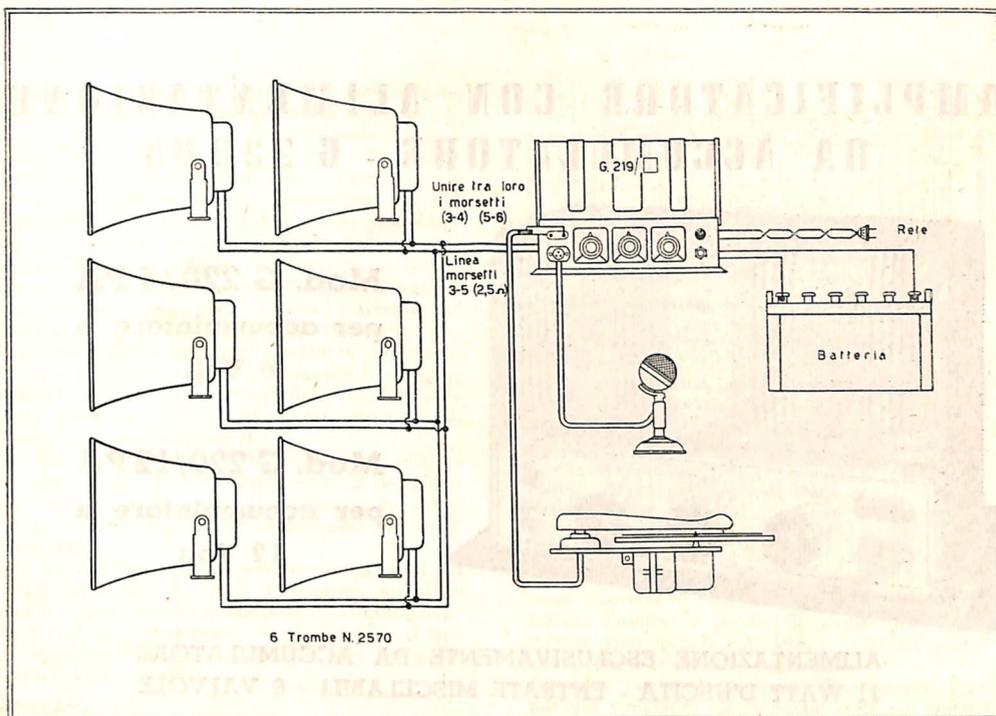
Esempio di impiego in unione a 6 trombe tipo 2570, microfono e complesso giradischi.
