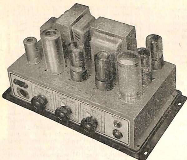
Lo chassis dell'amplificatore G 220-PA senza il coperchio metallico di protezione. Le valvole sono disposte nell'ordine, da sinistra a destra: 12AT7 - 12SL7 (6SL7) - 6V6 - 6V6. Le due sul lato destro sono le 6X5 raddrizzatrici.
