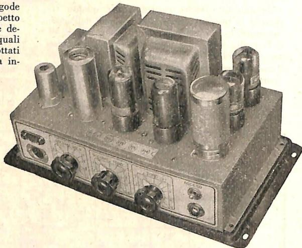
fetto dell'azione del controllo di tono che, passando per valori intermedi, sui 10.000 Hz attenua il segnale di 20 dB.
