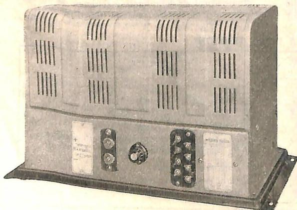
L'amplificatore G 220-PA visto dal lato posteriore. Si scorgono: morsettiera di attacco per l'accumulatore, fusibile di protezione, morsettiera d'uscita e la tabellina con le indicazioni dei collegamenti per le diverse impedenze d'uscita.
