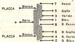
Schema del trasformatore e tabella delle connessioni per ottenere i diversi valori d'impedenza.
