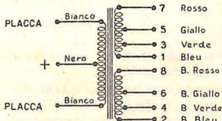
Schema del trasformatore e tabella delle connessioni per ottenere i diversi valori d'impedenza.
