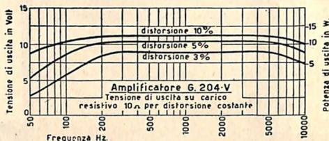
Potenza, tensione d'uscita e percentuale di distorsione.
