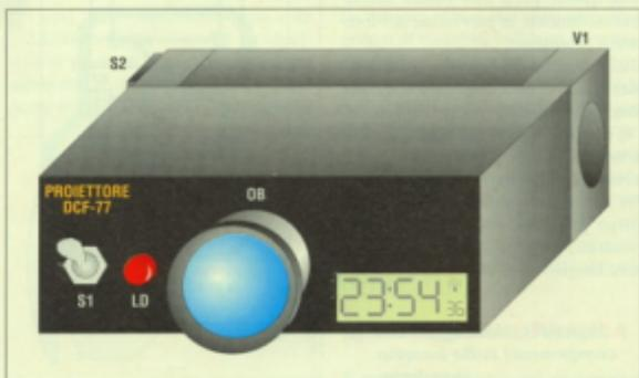
**Figura 5. Proiettore con modulo optional monitor.**
