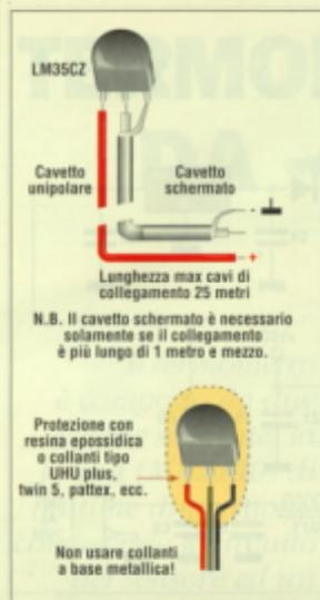
**Figura 4. Collegamento della sonda e sua impermeabilizzazione.**
