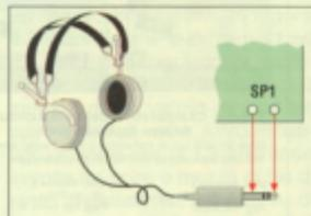
**Figura 5. Collegamento di una cuffia all'uscita di bassa frequenza.**
