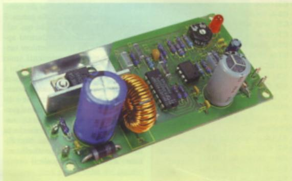
continua collegata al suo ingresso. In questo primo articolo di una serie che intendiamo proporre sui convertitori DC-DC, ci occupiamo appunto del tipo Step-up (in salita), di cui andiamo ad illustrare il principio di funzionamento.
