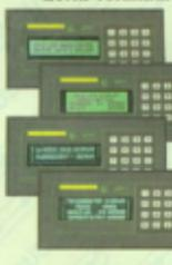
Pannello Operatore, a basso costo, con contenitore standard DIN da 96x192 mm. Disponibile con display LCD Retroilluminato o Fluorescente nei formati 2x20 o 4x20 caratteri; Tastiera da 16 tasti; comunicazione in RS 232, RS 422 o Current Loop; Buzzer; E' in grado di contenere fino a 100 messaggi; 4 ingressi optoisolati, acquisibili tramite la linea seriale ed in grado di rappresentare autonomamente 16 diversi messaggi.
