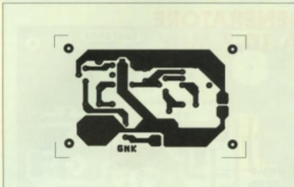
Figura 2. Basetta stampata del generatore vista dal lato rame in dimensioni naturali.
