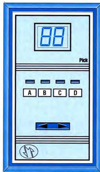
**Interfaccia radio**, è una interfaccia telefonica che permette di far comunicare apparati radio anche full duplex con la linea telefonica. Tra le molteplici funzioni vi è quella del collegamento al sistema Pick. Pertanto via radio è possibile svolgere tutte le funzioni dei telecomandi globali e del telefono (tutti i componenti+2 circuiti stampati).
