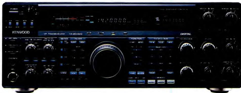
gneria di qualità si fonde con la semplicità estetica delle forme che accolgono un'ampia gamma di prestazioni, come il DSP (processore di segnale digitale) incorporato e la sezione finale a MOS FET, una delle prime nel mondo dei ricetrasmittitori amatoriali. Il risultato è un'eccezionale purezza del segnale di trasmissione e una eccellente qualità acustica, un nuovo caposaldo per le comunicazioni HF. E' estremamente facile da utilizzare
