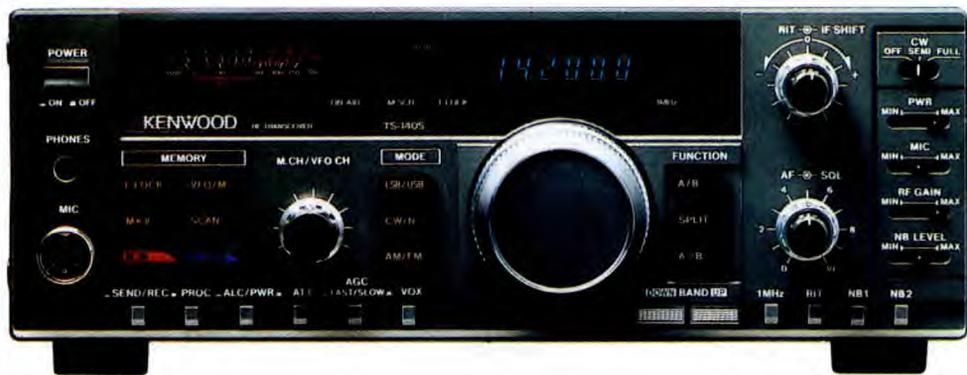
mica da 500 kHz a 30 MHz. Alte prestazioni in tutti i modi si accompagnano a numerose funzioni appositamente studiate per facilitarne l'uso, quali ad esempio 31 memorie, doppio Noise Blanker con controllo di livello, full break-in e semi
