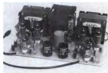
**KIT PREAMPLIFICATORE VALVOLARE STEREO** cod. IBF9302 completo di alimentazione. Adatto all'impiego in unione all'amplificatore di potenza a valvole IBF9211. Possiede i controlli dei toni alti e bassi, del bilanciamento e del volume. Il Kit comprende il circuito stampato a doppio spessore, 4 valvole ECC82, tutti i componenti passivi necessari alla realizzazione incluso il trasformatore di alimentazione. **L. 248.000.**
