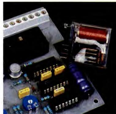
suo alloggiamento ad incastro. Con l'aiuto di un ohmmetro a batteria, collegato come prova circuiti, cercare sullo schema i collegamenti che si stabiliscono per l'arresto e la marcia, come indicato a titolo di esempio in **Figura 7**. Dopo aver ben definito questi collegamenti, rimane soltanto da realizzare le stesse connessioni ai morsetti, mediante i terminali del relè a quattro contatti.
