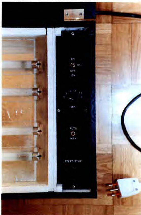
**Figura 7. (A sinistra). Vista del pannello di controllo. Rivestito di nero con le scritte serigrafate, il box assume un aspetto elegante. Figura 8. (A destra). Pannelli di supporto della mascherina di controllo. Figura 9. (Sotto). Schema elettrico del bromografo presentato sul n° 43 di Fare Elettronica.**
