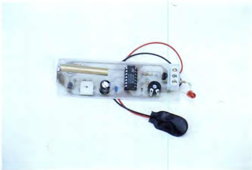
Per rendere ancora più completo ed efficiente un impianto antifurto per auto o moto, è necessario che l'allarme entri in funzione anche quando qualcuno tenta di spostare il veicolo, magari per caricarlo su un camion e farlo sparire rapidamente, alla faccia dell'impianto volumetrico! Non a caso tutti gli
