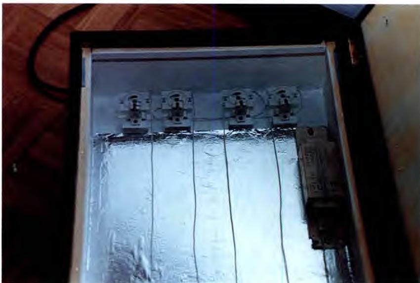
**Figura 5. Fissaggio di portatubi e portastarter (particolare).**
