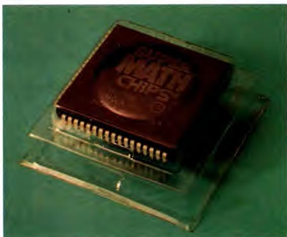
**Box di protezione.** Alcuni coprocessori come i SUPER MATH di Chips & Technologies, sono protetti da un box plastico a cappuccio che evita, durante l'installazione su zoccolo, urti di rottura dei pin e accidentali contatti con scariche elettrostatiche. A inserimento avvenuto il box si separa automaticamente dal chip.
