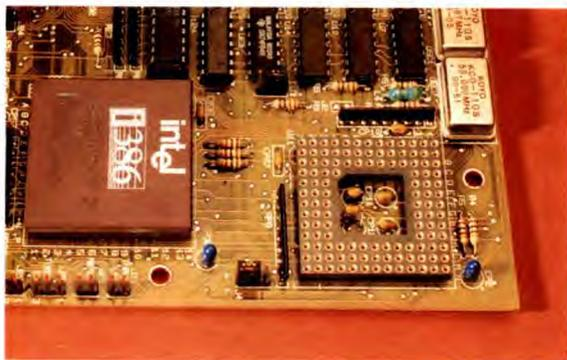
**Coprocessore 387 DX.** Piastre madri con CPU 386 DX richiedono coprocessori equivalenti, quindi tipo 387 DX, di forma quadrata e con pin sporgenti, dunque veri e propri piedini (5a) da infilare nei fori dell'apposito zoccolo, localizzabile nelle immediate vicinanze del chip principale (5b).
