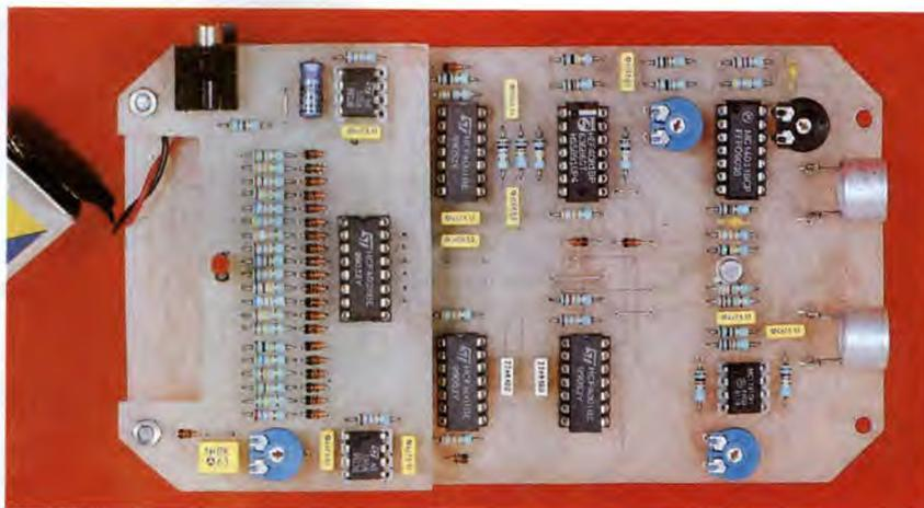
altro motivo: se la distanza che separa il radar da un ostacolo fosse eccessiva, il contatore rischierebbe di tornare a zero, dopo aver percorso un primo giro, per poi proseguire: il risultato della misura sarebbe sbagliato. Lo stesso fenomeno si produrrebbe se la capacità del radar non fosse sufficiente in termini di potenza, tanto da non poter registrare nessuna eco di ritorno. Per questi motivi i diodi D4 e D5 rilevano la particolare posizione 1001 del secondo
