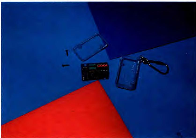
Tototron presenta sul frontale tre diodi led relativi ai segni 1-X-2 e un pulsante ben allineato alla superficie plastica con il quale attivare il circuito generatore random. Tenendo premuto il pul-
