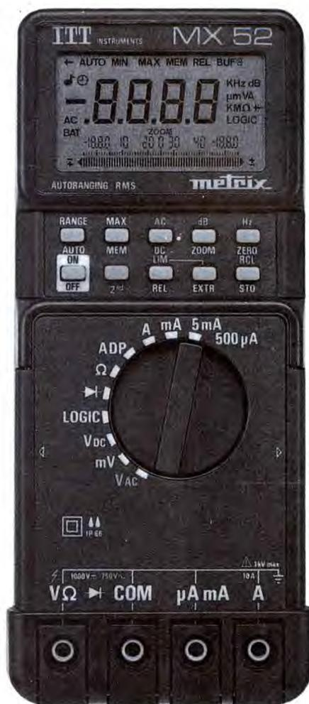
egregiamente la pila di alimentazione e il fusibile di protezione. L'elegante estetica è all'altezza della sofisticata elettronica interna. L'ampio display assicura 5000 punti di risoluzione per una lettura digitale e analogica (bargraph da 50 divisioni). Da tastierino è possibile impostare sia il modo ZOOM che lo Zero centrale (espansione automatica x 5; risoluzione 0,4%). La commutazione delle portate è automatica
