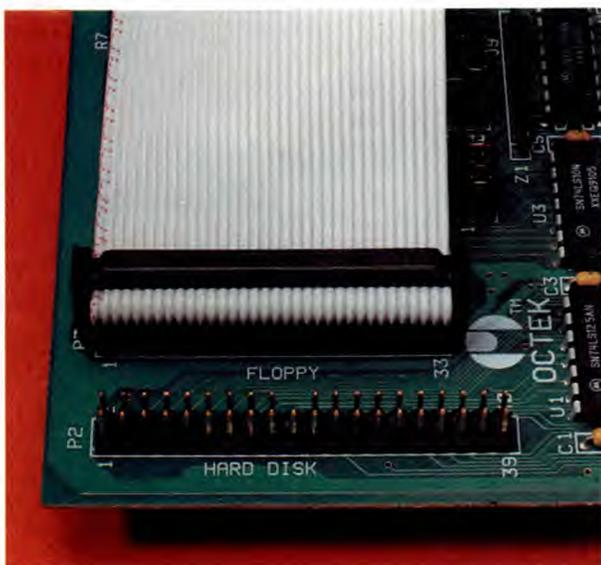
**5.** La comunicazione tra interfaccia e floppy drive avviene mediante un cavetto multipolare a piattina di 34 poli (17+17); un contrassegno a tracce di colore rosso su tutta la lunghezza evidenzia la posizione del pin numero 1, per evitare accidentali inversioni in fase di montaggio del computer.
