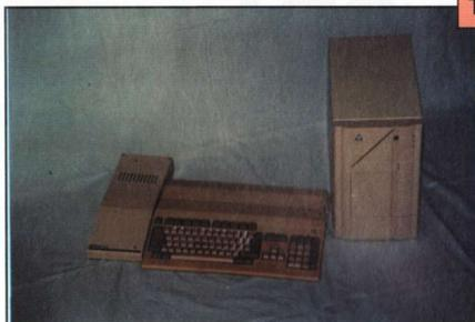
Infine l'opera è compiuta: l'Amiga 500 nella vecchia versione con HD SCSI esterno a fianco di quella nuova che in più ha il MIDI. Praticamente il nostro prototipo ora assomiglia molto ad un PC MS-DOS, eccetto che per tre particolari: la tastiera, i connettori posteriori, e soprattutto il sistema operativo multi-tasking! Inscatolatelolo come volete, ma in fin dei conti l'Amiga è sempre unico...
