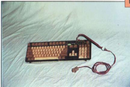
Nel rispetto del non-spreco abbiamo riutilizzato la tastiera originale che inoltre rispetto a quelle esterne è dotata dei led di Power e del Drive. La parte più problematica è stata la realizzazione della scatola che la contenesse: abbiamo dovuto segare e modificare irreversibilmente i gusci dell'A500 chiudendo il lato posteriore con una lastra di plexiglass.
