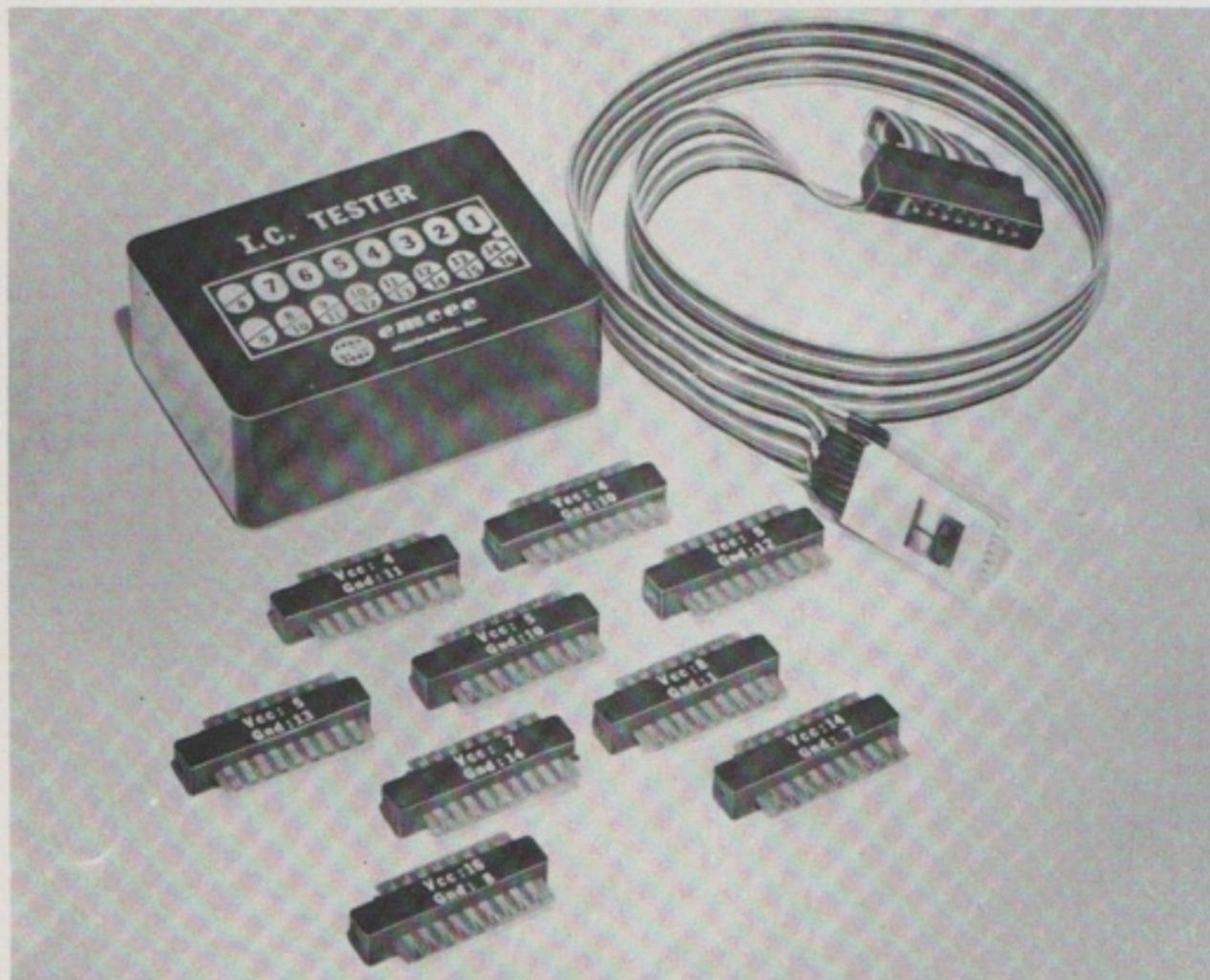
Fig. 1 - Tester per la prova di circuiti integrati DTL o TTL, a 14 o 16 piedini (zoccoli DIL), utilizzabili senza togliere gli IC dai CS.
