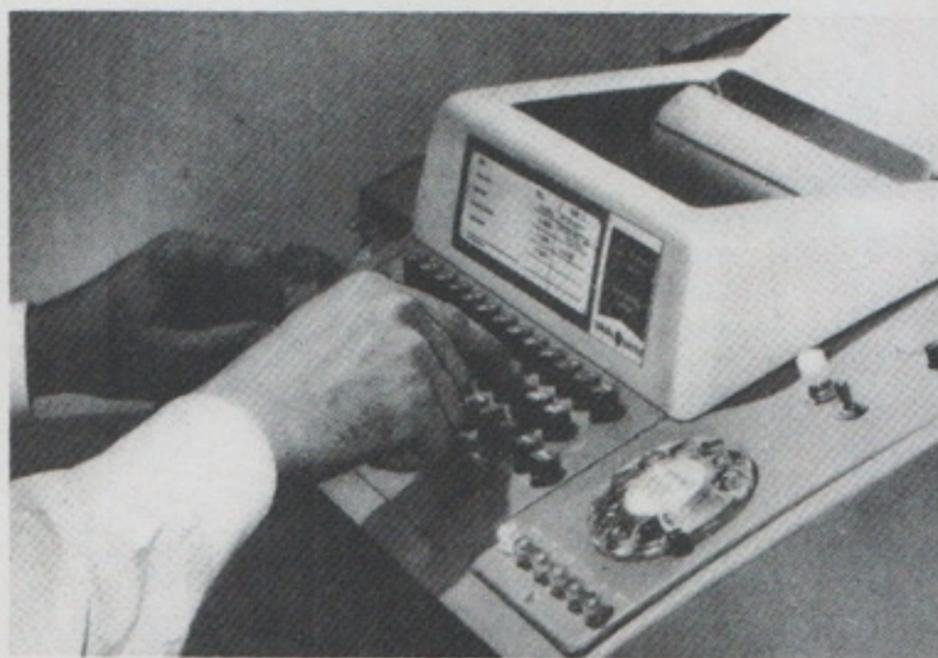
*Fig. 1 - Fotografia illustrante l'aspetto tipico di una unità per ufficio, attraverso la quale è possibile mettersi in contatto diretto con il computer principale. La comunicazione viene stabilita formando un numero telefonico attraverso il selettore visibile sul pannello, dopo di che i dati del problema da risolvere vengono impostati battendo dei tasti in codice, come con una normale macchina da scrivere.*
