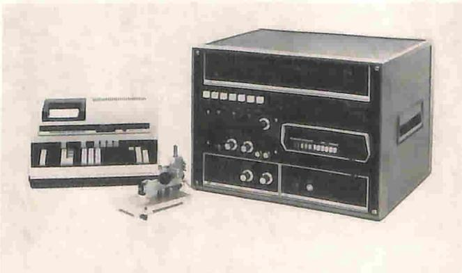
Il nuovo impianto automatizzato per la prova di fattori di resistività può essere usato per effettuare lo studio analitico di materiali semiconduttori, in modo rapido e preciso. L'apparecchiatura presenta inoltre una notevole flessibilità di impiego in altri campi specifici.
