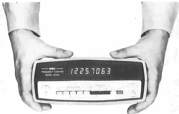
Frequenzimetro mod. 6243A capace di misurare da 20Hz a 1250MHz. La sensibilità è costante su tutta la gamma e vale 10mV. La risoluzione è selezionabile da 0,1Hz a 10kHz.
