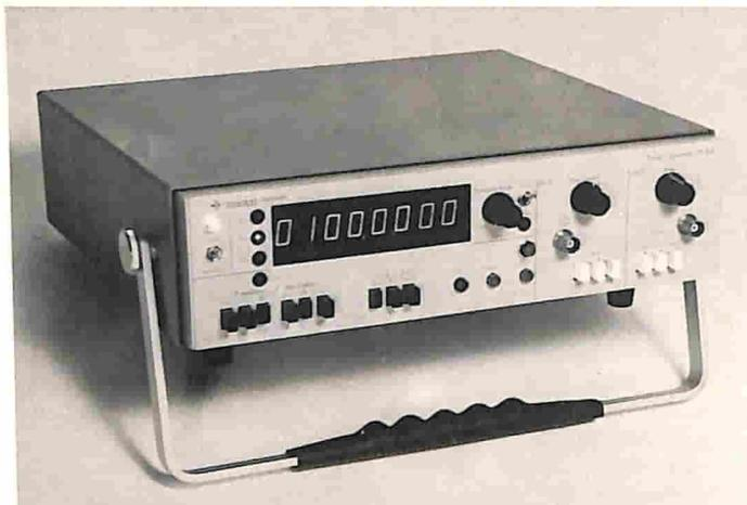
Il nuovo contatore di frequenza è stato realizzato in un contenitore di tipo razionale e moderno, provvisto di supporto regolabile che consente di inclinarlo rispetto al piano di lavoro.
