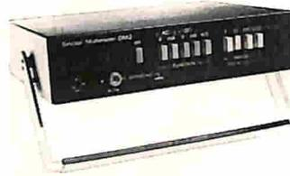
L'alimentazione viene assicurata da una batteria interna da 9 V oppure da un alimentatore esterno.
