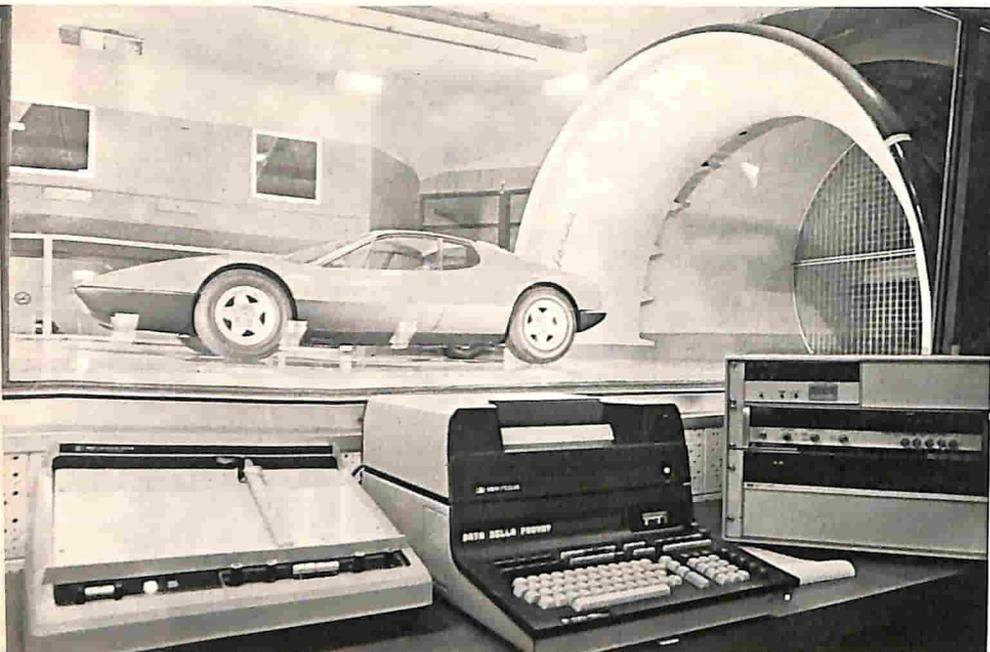
Fig. 2 - Il sistema di elaborazione ed acquisizione dati HP-IB utilizzato dalla Pininfarina.
