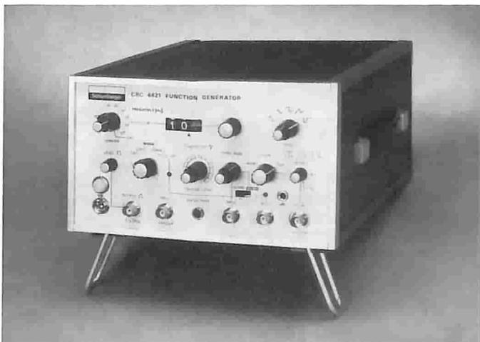
Generatore di funzioni mod. 4421 AM/FM genera forme d'onda sinusoidali, triangolari, quadre, rampe ed impulsi nella gamma di frequenze da 0,001Hz a 10,5 MHz.
