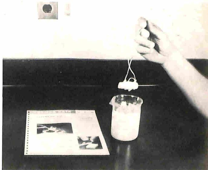
Esempio tipico di impiego del nuovo materiale per il rivestimento mediante immersione di un componente.
