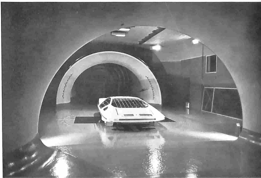
Fig. 1 - Una autovettura in prova nella galleria del vento realizzata dalla Pininfarina.
