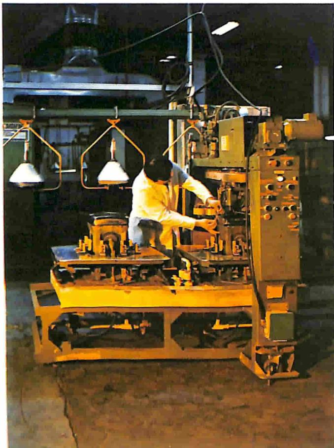
Particolare della linea per l'applicazione del pannello antiriflettente al CRT.
