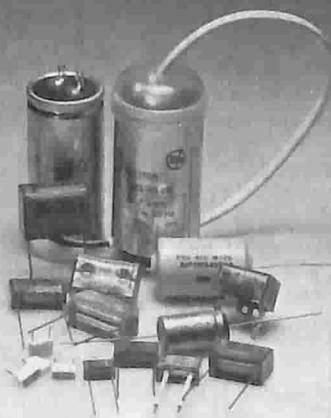
Condensatori a film plastico metallizzato e a carta metallizzata. Antidisturbo e unità RC con le principali omologazioni europee.
