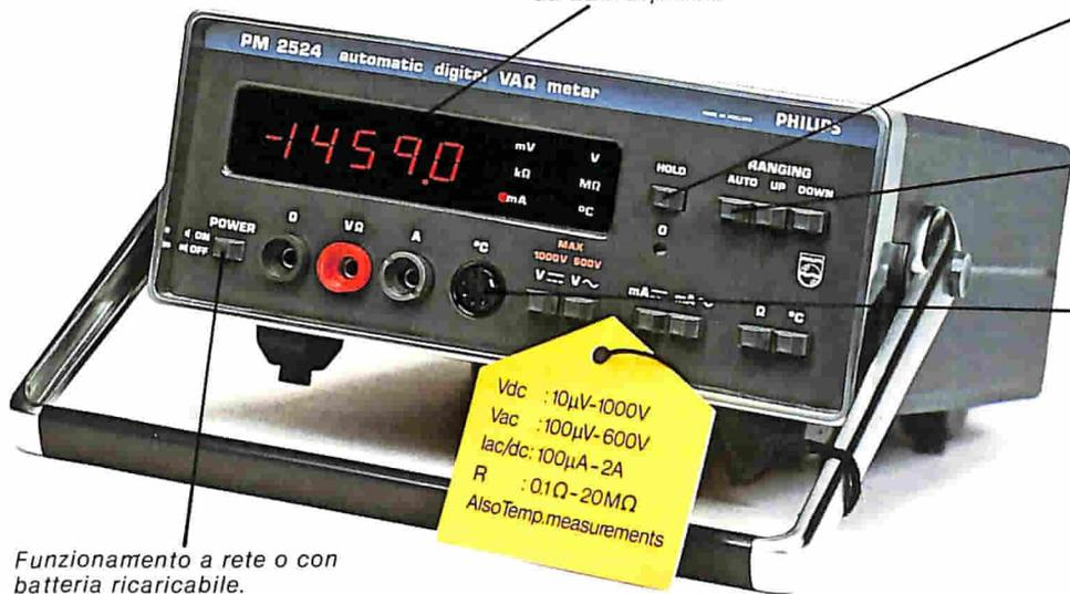
Funzionamento a rete o con batteria ricaricabile.
