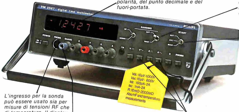
L'ingresso per la sonda può essere usato sia per misure di tensioni RF che di temperatura. Il display fornisce le misure direttamente in °C.
