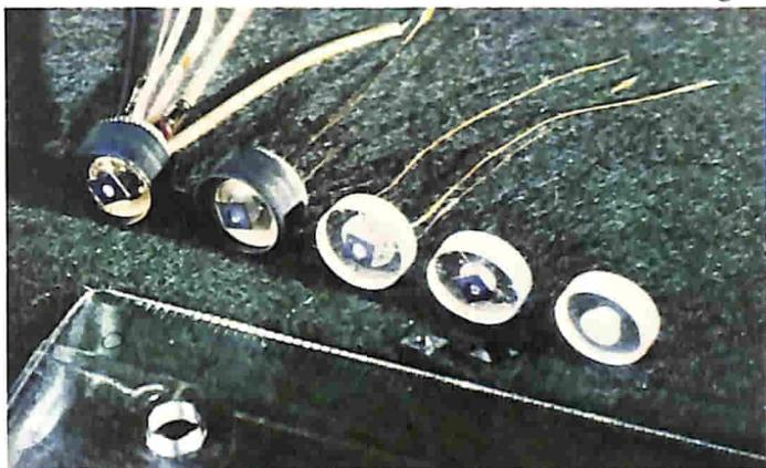
Fig. 9 - Assemblaggio degli elementi di misura (da destra a sinistra) a) Piastra di vetro forata b) Chip fissato al disco di vetro c) Il circuito stampato viene fissato e vengono saldati i cavi di connessione d) Un anello forzato è usato come capsula protettiva e) Viene saldato il diodo di compensazione.
