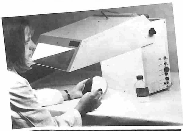
Cappa aspirante portatile per il filtraggio dell'aria in laboratori dove vengono sviluppati vapori, polveri e gas dannosi alla salute.
