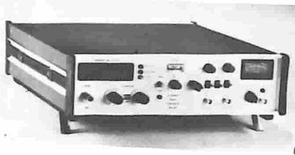
Le principali caratteristiche dell'SSG-520 sono una rapida selezione della frequenza (con una risoluzione di 100 Hz), un eccellente controllo dell'uscita (su un range di 119 dB), perdite estremamente basse, una straordinaria flessibilità di modulazione e la facility SINAD (il metodo "12 dB SINAD" è un criterio preferenziale per esprimere la sensibilità di un ricevitore mobile).
