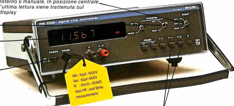
Le misure del valore efficace reale possono essere con accoppiamento in c.a. per misurare solo i segnali a.c. o con accoppiamento c.c. per misurare segnali c.a. più una componente c.c. sovrapposta.
