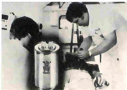
densatore MPF H 32/5000 C, adatto in particolare per la utilizzazione nei defibrillatori, sono: capacità di 32  $\mu\text{F}$   $\pm 10\%$ , tensione nominale di 5000 V, contenuto d'energia di 400 Ws, 25.000 scariche, tensioni di prova strato/strato 6KV/min, strato/contenitore 11 kV/min. Le dimensioni del contenitore sono 115 mm  $\varnothing$  x un'altezza di 153 mm con protezione di rottura.
