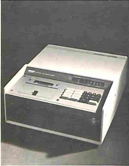
Il sistema 35 infine, che è il package hardware - software di data logging basato sull'LSI11 dalla DEC. Sistema fornito a chiavi in mano, configurabile completamente sulle esigenze dell'utente, che opera con un software real time, multifunzione, specificatamente disegnato per il data logging e il controllo di processo.
