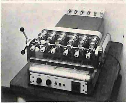
Utilizzando sei fusi coordinati, si possono produrre sei bobine ogni ciclo, e nello stesso tempo la durata del ciclo stesso è accorciata dall'alta velocità di mandrini.
