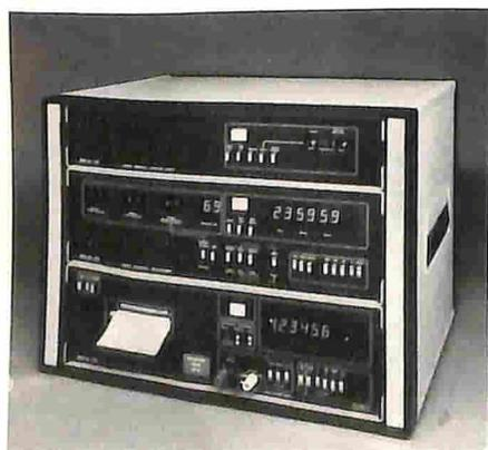
Perchè queste premesse? Semplicemente perchè alla Datron è stato sufficiente progettare lo "SCANNER" cioè solo la parte acquisizione quindi, abbinarlo ai suoi prodotti già esistenti per ottenere il "DATA LOGGER" più versatile del mercato più preciso e con i range più vasti (100  $\mu$ V ÷ 1000 V).
