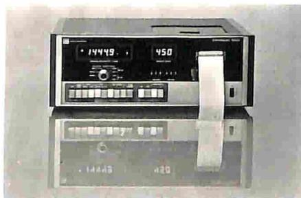
nazione a qualunque punto. A ciascuno dei 6 allarmi è collegata una spia-led e un relè SPDT di uscita. Quando sono richiesti più di 6 allarmi un dispositivo aggiuntivo permette la programmazione di 128 diversi allarmi a 2 livelli.
