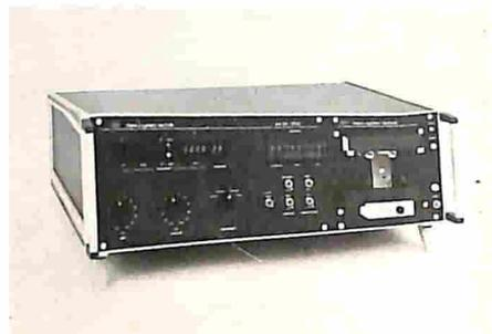
Una versione semplificata del sistema KRS è costituita dal *Digiscan 10 PRC della MESS+SYSTEM Technik* con ingressi da segnali analogici e/o da termocoppie, 10 nella configurazione minima, estendibile fino a 100 con orologio in tempo reale e stampante, costituisce un Data Logger completo particolarmente economico (prezzi a partire da Lit. 2.200.000) e quindi alla portata di una forte fascia di utilizzatori.
