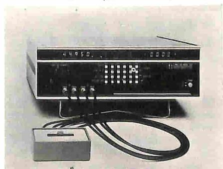
di misura dai 100 ai 200 ms; precisione di base dello 0,1%; selezione automatica della portata; tre livelli del segnale di prova selezionabili; vasto campo di misura per tutte le funzioni. Opzioni facilmente aggiungibili: interfaccia IEEE, interfaccia per dispositivo di inserzione dei componenti, interfaccia per telescrivente.
