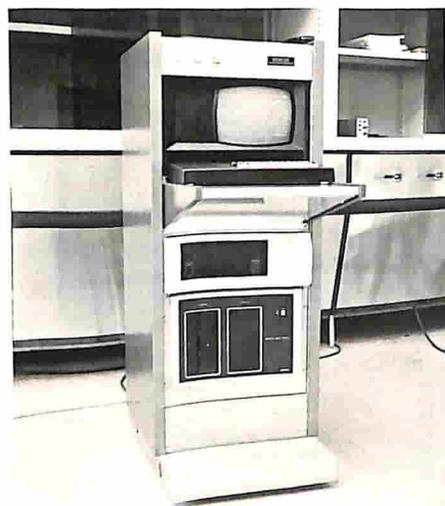
Lo ZEST può essere programmato per eseguire qualsiasi elaborazione sui dati acquisiti e per scandire i dati in ingresso ed eventualmente pilotare attuatori secondo frequenze e modalità variabili anche in funzione delle elaborazioni stesse.
