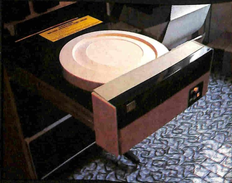
dispone di 100 canali di ingresso espandibili a 200 mediante unità satellite e ognuno di questi può accettare segnali derivati pressochè da ogni tipo di sensore o trasduttore, tra cui 9 tipi di termocoppie, 3 tipi di termoresistenze, trasmettitori di corrente, nonché segnali digitali e chiusure/aperture di contatti.
