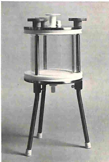
lisi dell'assorbimento atomico o per altre analisi strumentali con cui determinare e differenziare la filtrazione particolata di metalli pesanti da quella disciolta. In pochi minuti è possibile filtrare da 500ml a 6 litri di acqua potabile o torbida.
