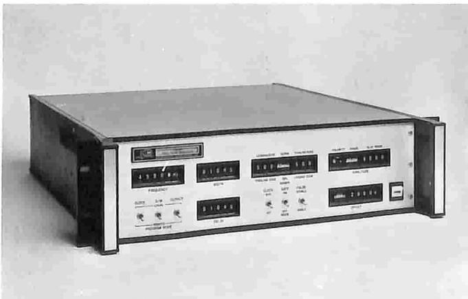
Generatore di impulsi mod. 1504 studiato per essere utilizzato con circuiti CMOS e bipolari. Lo strumento opera da 0,5Hz a 50MHz con tempi di solita / discesa da 3ns a  $800 \mu\text{s}$ . I tempi di ritardo / durata variano da 10ns a 1 s.
