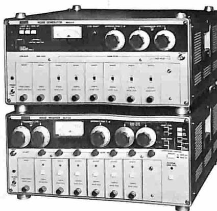
Analizzatore di rumore di intermodulazione per ponti radio mod. MEV 8 operante nella gamma 10kHz ÷ 18MHz adatto per sistemi con capacità compresa fra 24 e 2700 canali, con possibilità di estensione.
