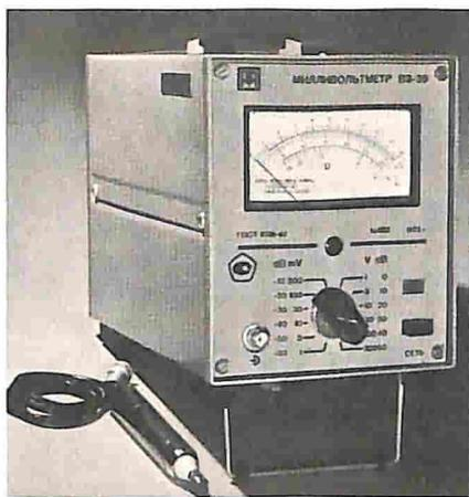
Fig. 5 - Millivoltmetro con scala valori da 0,1 a 300V operante nella gamma di frequenza da 10Hz a 10MHz.
