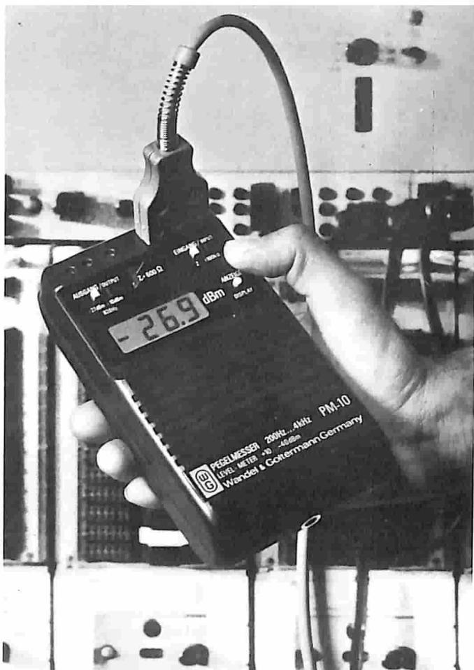
Il dispositivo digitale per la misura di livelli è uno strumento molto maneggevole, di grande utilità per il controllo di apparecchiature di trasmissione.
