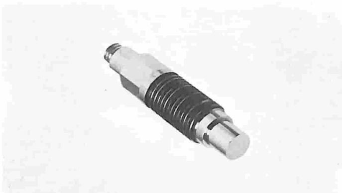
Trasduttore di pressione idraulica mod. 108A02 di costruzione particolarmente resistente. Il dispositivo, che ha una frequenza di risonanza di 300kHz è provvisto di un dispositivo elettronico integrato che dà un'uscita di 10V su 100 $\Omega$ .
