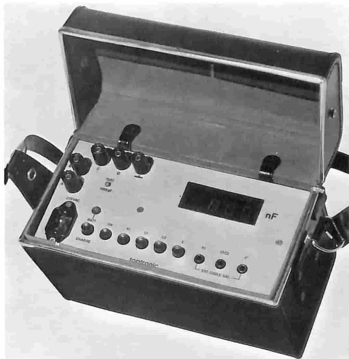
Ponte digitale Toptronic mod. X74148 realizzato per il controllo di sbilanciamento o capacità mutua su cavi telefonici.
