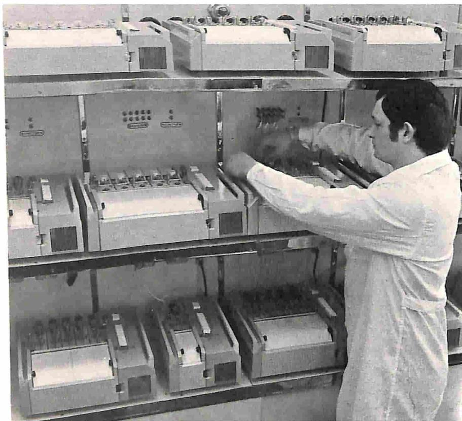
Fig. 2 - Operazioni di controllo al banco di prova di registratori rapidi prima della commercializzazione.
