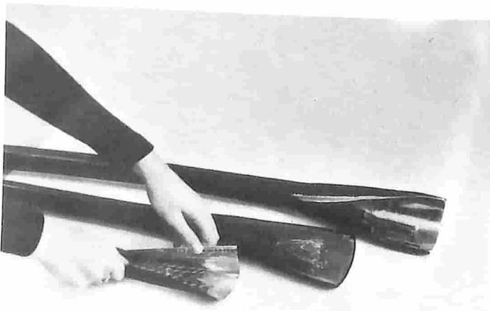
Esempio di tecnica di applicazione dell'involucro schermante su cavi multipli.
