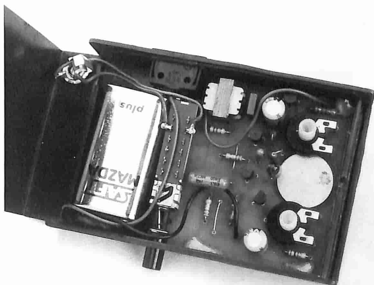
L'interno dell'apparecchio a montaggio ultimato. Per l'alimentazione è sufficiente una comune pila miniatura a 9 volt.
