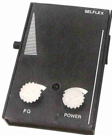
I due trimmer potenziometrici che controllano la frequenza e l'ampiezza della tensione di uscita possono essere regolati dall'esterno tramite due manopole.
