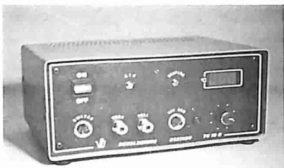
Stazioni di saldatura (in alto) e di dissaldatura (qui sopra). La temperatura si legge sul display. Sono prodotti Videobit.
