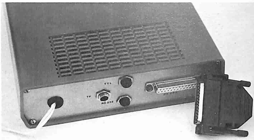
Il chip dell'AMI e il trasformatore di linea (sotto). Sopra: il retro del modem con il connettore full RS232, le prese «3X» TTL e RS232 nonché la presa per il telefono.
