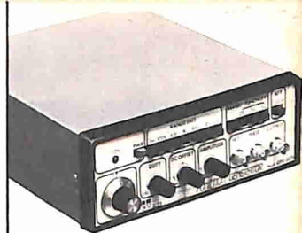
GENERATORE DI FUNZIONI MOD. GFG 8015
