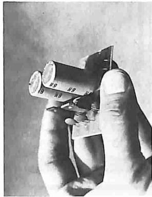
L'alimentatore fornisce una tensione duale di 8+8 volt. Componenti: C1, C4 = 1.000 uF 16 VI, C2, C3, C5, C6 = 100 KpF, D1-D4 = 1N4001, U1 = 7808, U2 = 7908, TFI = 220/12+12 0,5 A.
