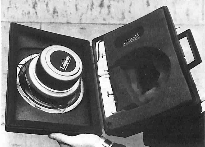
un altoparlante più Hi-Fi possibile, (potete trovarlo presso la Semiconduttori) un paio di portapile, jack, potenziometro, interruttore e cavo schermato. Fra gli accessori: un imbuto (eh sì, è proprio un imbuto) di diametro un poco superiore a quello dell'altoparlante, del tubo di gomma molto flessibile e della pasta siliconica per sigillare la cassa. Anche facendo conti molto in eccesso non vi dovrebbe costare più di quarantamila lire.
