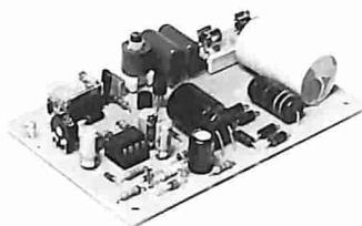
Questo dispositivo corredato da un captatore magnetico ed usato in coppia con il KS 484 permette la ripetizione di chiamate telefoniche nell'ambito domestico senza l'ausilio di antenne o fili appositi.
