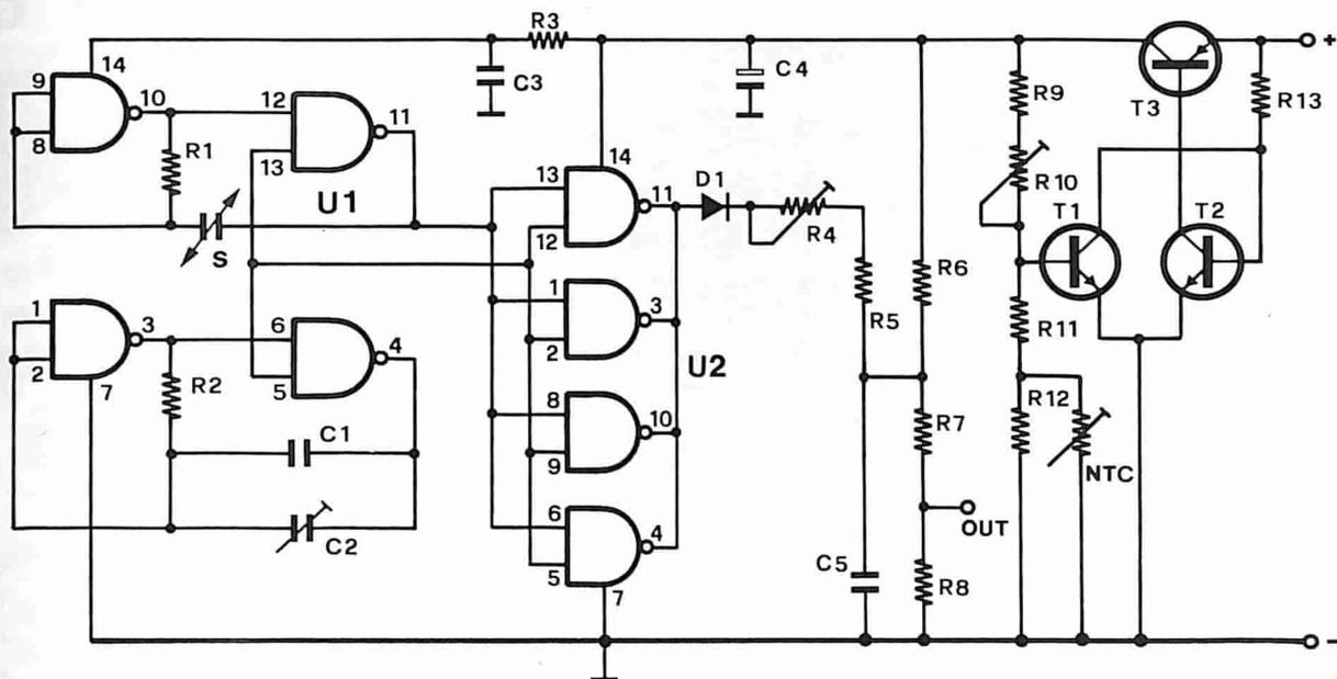
le di uscita ed è inoltre stato previsto un circuito per stabilizzare la tensione di alimentazione. La stabilizzazione è ottenuta per mezzo dei transistor T1, T2 e T3. Il transistor T1 funziona come regolatore in serie; la tensione di riferimento è data dalla tensione base-emettitore di T2, la cui corrente di collettore pilota a sua volta T3, il quale funziona esclusivamente da amplificatore. L'influenza delle variazioni di temperatura sulla tensione di riferimento vie-
