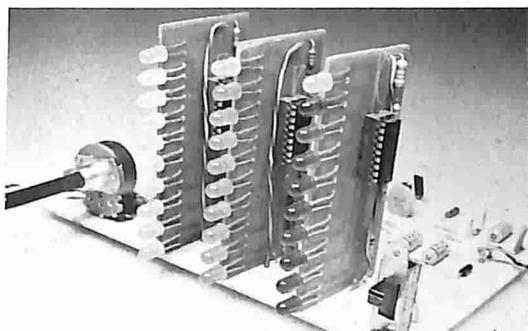
Tenete sempre sotto controllo la risposta in frequenza del vostro impianto hifi; ecco un visualizzatore a tre bande che vi permette di analizzare il programma audio nei bassi, medi e acuti. Date un tocco di classe al vostro impianto con questo rivoluzionario VU meter a tre bande; funziona sia in casa che in macchina. Di semplice realizzazione, viene fornito in kit completo di tutti i componenti necessari alla costruzione con tre stampati relativi ai visualizzatori e un quarto per i filtri.
