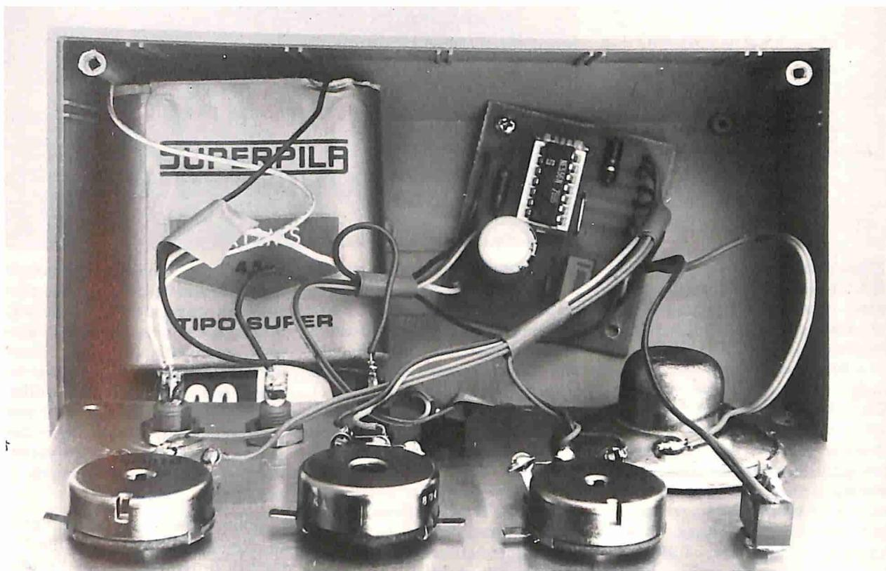
Chirp Box deve necessariamente essere munita di un contenitore che funga anche da supporto meccanico per i suddetti. Per il prototipo è stato adottato un mobiletto a consolle con la plancia in plastica ed il coperchio in metallo, economico ma abbastanza ampio per le pile.
