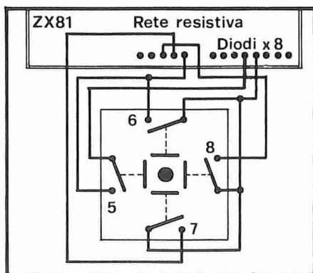
Per collegare il joystick è necessario aprire il computer e saldare cinque fili al connettore della tastiera senza che il pettine sia estratto.
