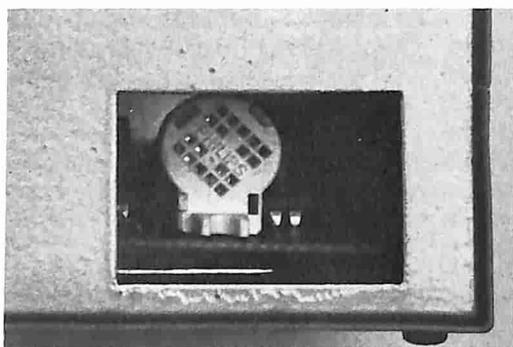
La basetta dell'igrometro, a destra, può essere collegata ad un display per l'indicazione digitale: noi abbiamo usato il millivoltmetro già presentato a gennaio di quest'anno.
