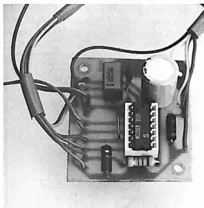
poichè non sono questi i nostri scopi, siamo riusciti a complicare la vita al nostro onesto generatore di onde quadre utilizzando la seconda sezione dell'U1 per ottenere un dente di sega (è il timbro della fondamentale del violino!), la cui frequenza è controllata dal potenziometro R4.
