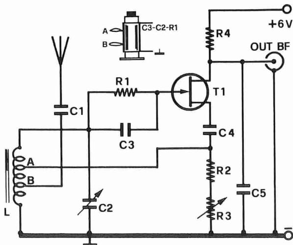
Componenti: R1 = 1,5 Mohm, R2 = 2,2 Kohm, R3 = 2,2 Kohm pot. lin., R4 = 4,7 Kohm, C1 = 5,6 pF, C2 = 30 pF variabile, C3 = 100 pF, C4 = 1.500 pF, C5 = 47.000 pF, T1 = 2N3819 o eq., Val = 6 volt.
