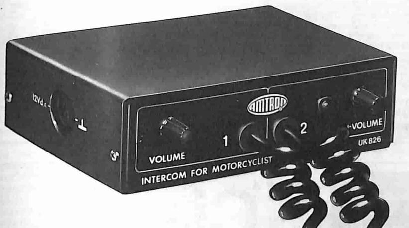
**Q**uesto dispositivo (UK 826) permette di dotare di un apparato intercomunicante i due caschi rispettivamente del pilota e passeggero, consentendo la libera conversazione in modo si-
