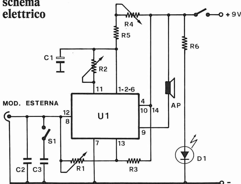
Il circuito, come si vede, è ultrasemplice perché è utilizzato un solo integrato: si tratta del 556, comunissimo. I comandi, a parte l'interruttore generale di alimentazione, sono R1 = PITCH; R2 = MODULATION RATE; R4 = MODULATION SPEED; S1 = HI-LOW.
