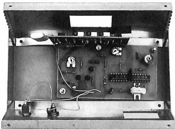
*Il circuito, realizzato su di una basetta stampata, può essere chiuso in un contenitore: è chiaro che bisognerà provvedere ad una finestrella affinché l'aria umida possa interessare il sensore!*
