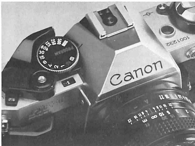
tramite l'accensione di un particolare valore sulla scala dei diaframmi e una P verde ci ricorda l'attivazione dell'esposizione programmata. In caso di tempi di esposizione maggiori di un trentesimo, la P lampeggia per ricordare di mantenere la macchina ferma. Se preferiamo invece usare solo l'automatismo dei diaframmi, possiamo selezionare il tempo di aper-
