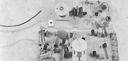
RADIOCOMANDO 3 CANALI RC4 RX
