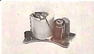
Alimentazione 3÷12 Vcc. Il suono è regolabile da bitonale a ronzio continuato tramite apposito trimmer. Ideale per apriporta, frecce di direzione, fine trasmissione, strumenti di laboratorio, cercametalli. (cm 3x4x2,5) L. 1.500
