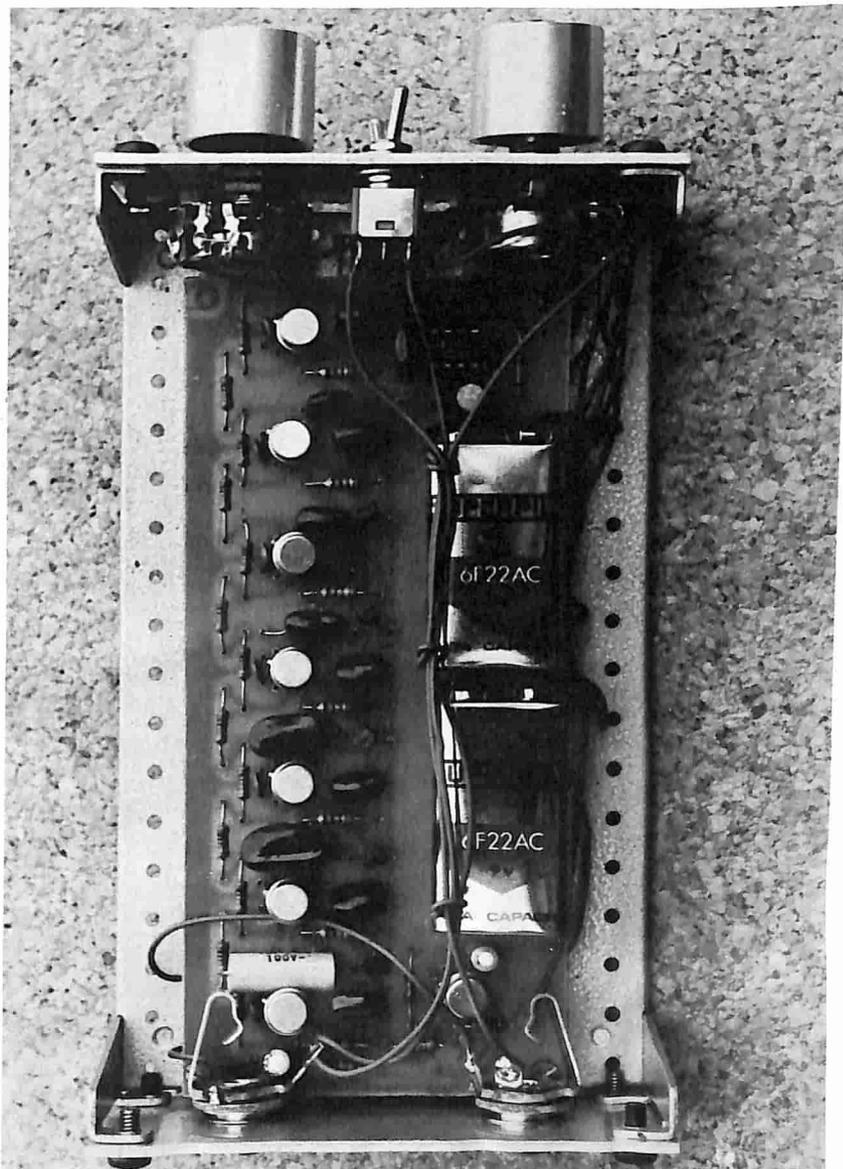
*Le due pile sono alloggiare nell'apposito spazio previsto sulla basetta. Tutti i componenti sono racchiusi all'interno di un contenitore metallico Ganzerli serie mini de-luxe. Il funzionamento dell'apparecchio è evidenziato dall'accensione di un bellissimo led triangolare montato sul pannello frontale.*
