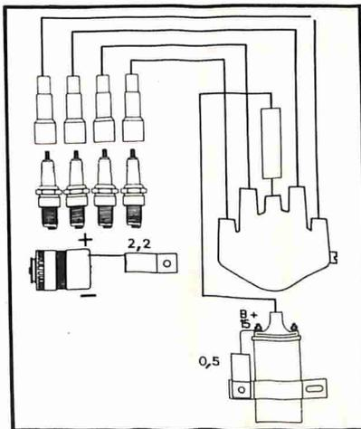
*bina ed una capacità da 2,2  $\mu$ F fra il positivo dell'alternatore e massa. Riportiamo quanto detto in un disegno e raccomandiamo di applicare anche un condensatore da 0,5  $\mu$ F fra positivo della bobina e massa.*
