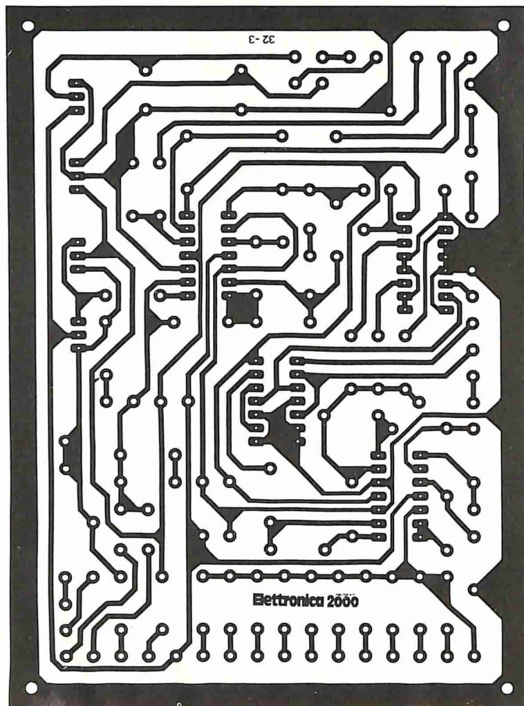
Circuito stampato lato rame in dimensioni naturali (codice basetta 52-3, lire 5.500). Sotto, prototipo a montaggio ultimato. L'apparecchio è alloggiato all'interno di un contenitore metallico Ganzerli serie mini-box.
