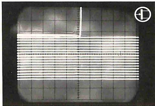
LOW; con S2 su HIGH basta moltiplicare il risultato per dieci). Più il beta è elevato, maggiore è il guadagno in corrente e, di conseguenza, maggiore sarà la distanza tra una curva e l'altra. Questa la posizione dei comandi per provare un transistor: oscilloscopio come per i diodi, S3 su OP, S2 su LOW se il transistor è di bassa o media potenza (su HIGH se di elevata
