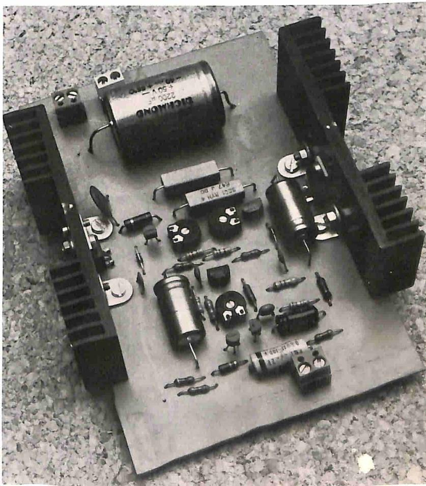
Stadio finale, costruito per avere una potenza massima di 25 watt. I dissipatori ed i transistor Darlington, usati come finali, sono direttamente applicati al circuito stampato. Per pilotare correttamente il finale suggeriamo di fare uso del preamplificatore miscelatore presentato nel mese di novembre e del modulo di controllo toni e regolazione volume apparso in dicembre.
