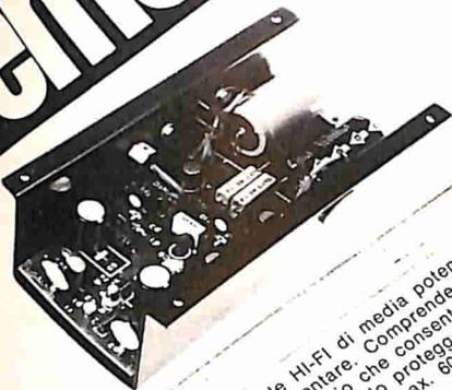
Amplificatore finale HI-FI di media potenza a simmetria quasi complementare. Comprende il circuito di rettificazione e filtraggio che consente di alimentarsi in c.c. che in c.a. e lo protegge contro le inversioni di polarità. Potenza max. 60W su 4 Ω.
