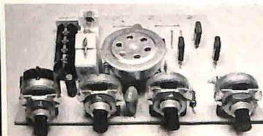
Luci psichedeliche a controllo microfonic con tre canali di uscita. Alimentazione diretta da rete senza trasformatore, potenza di uscita 300 watt per canale. La confezione comprende basetta e tutto il materiale per il montaggio. **Lire 18 mila.**
