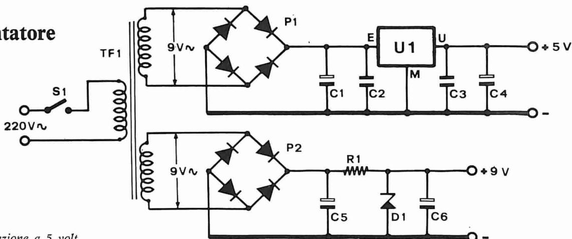
Nella sezione a 5 volt viene utilizzato l'integrato 7805, in quella a 9 volt uno zener da 400 mW.
