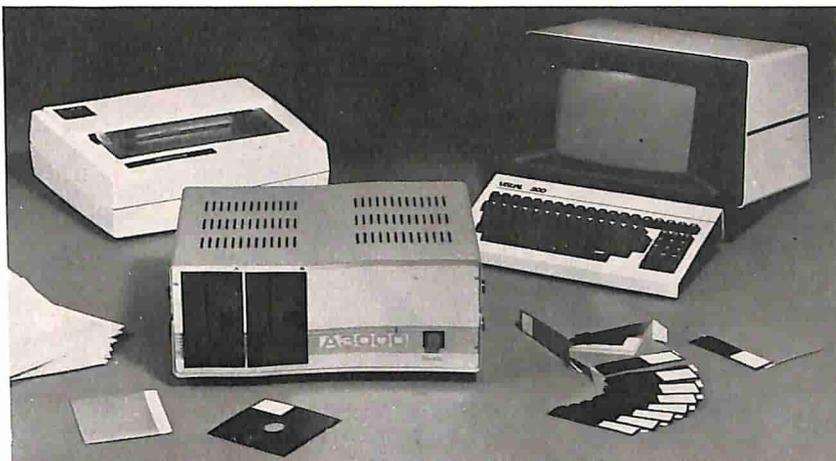
L'A3000 è un personal computer modulare la cui unità centrale fa uso del microprocessore 6502. In un elegante contenitore troviamo la scheda madre per la connessione dei vari moduli di funzione (max 8 in formato Europa 100 x 160 mm) e due mini floppy a doppia densità a singola o doppia faccia.
