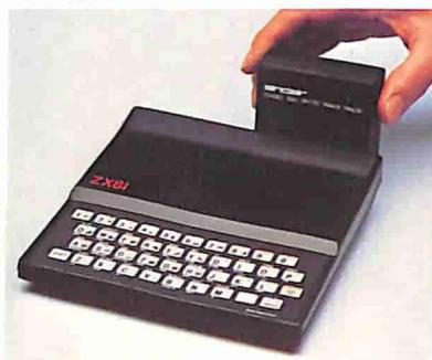
Disegnato per essere collegato ad entrambi i computer ZX 80 e ZX 81, il modulo ZX-RAM si connette con la semplice pressione alla porta di espansione posta sul retro degli apparecchi: la capacità di memorizzare programmi e dati aumenta di ben 16 volte, permettendo di sviluppare programmi più lunghi e complessi, di realizzare una vera e propria "banca dati" personale e di eseguire più sofisticati programmi della libreria ZX software.
