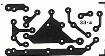
te verificare il funzionamento del circuito e provvedere alla sua taratura. Per questa operazione sono necessarie una radiolina FM ed un generatore di segnali o una qualsiasi altra sorgente sonora in grado di erogare una tensione di almeno 50 mV. L'apparecchio dovrà essere alimentato con una tensione di 6 volt e il segnale BF dovrà essere applicato, dopo aver interrotto il collegamento tra R1 e C1, tra l'elettrodo positivo di C1 e massa. Regolando il compensatore C5
