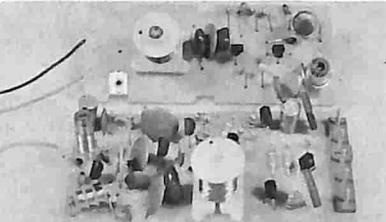
RADIOCOMANDO 3 CANALI RC4 RX
