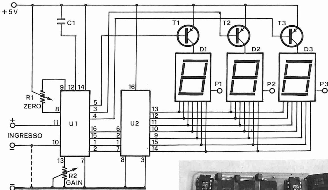
**COMPONENTI:** R1 = 47 Kohm trimmer (azzeramento), R2 = 10 Kohm trimmer (sensibilità), C1 = 220 KpF, T1 = BC206, BC327, T2 = T1, T3 = T1, U1 = CA3162E, U2 = CA3161E, D1 = MAN72A, D2 = D1, D3 = D1, VAL = 5 volt. Il circuito stampato del millivoltmetro (Cod. 33-5) è disponibile al prezzo di lire 2.500. Le dimensioni al naturale di tale basetta sono di mm 40 x 75.
