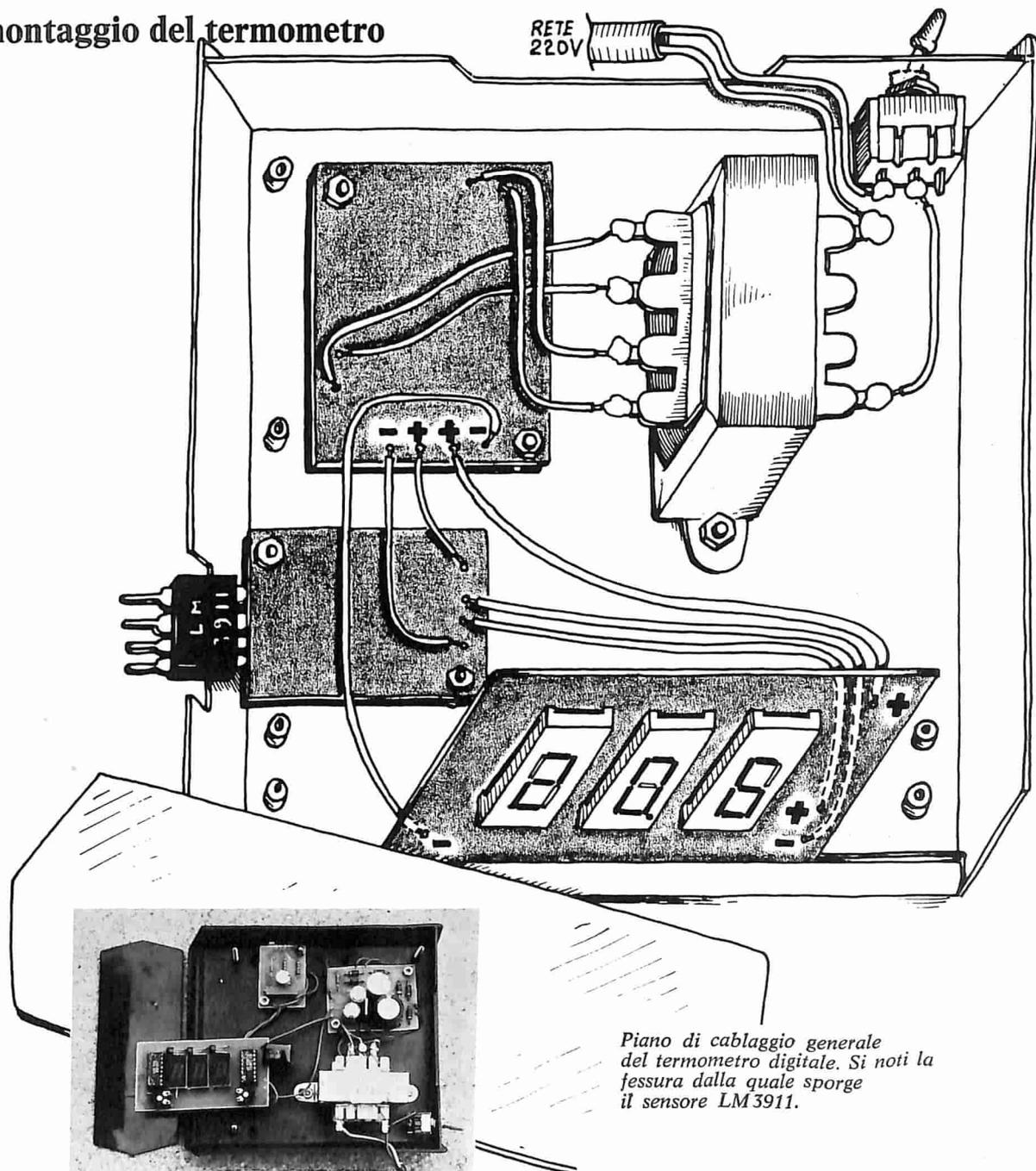
*Piano di cablaggio generale del termometro digitale. Si noti la fessura dalla quale sporge il sensore LM3911.*
