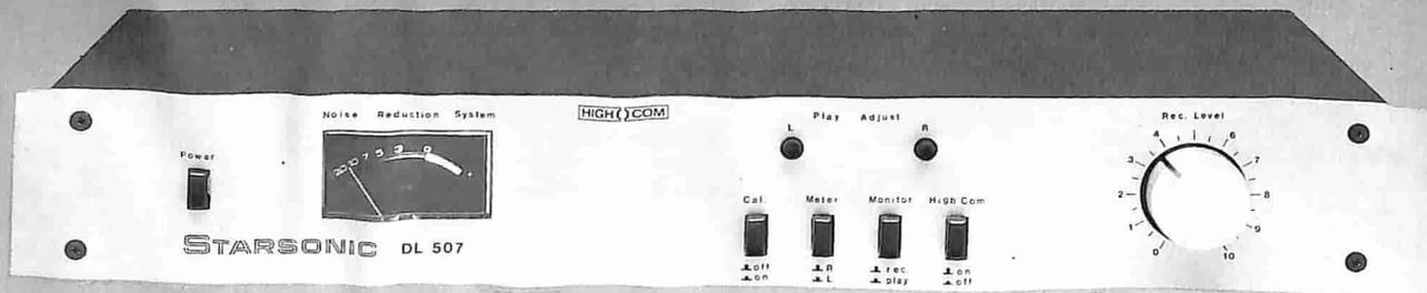
Sfruttando il principio High-Com della compressione-espansione dell'intera gamma audio, permette un abbattimento del fruscio di 20dB contro gli 8-10dB del sistema Dolby, presente nella maggior parte dei registratori.
