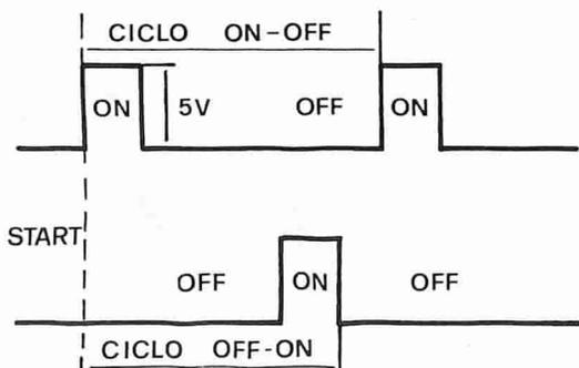
mente attivati, presentare o una tensione alta (circa 5 volt) o una tensione bassa (circa 0 volt). Queste uscite vengono definite dal costruttore AN0, AN1, AN2, AN3, acronimi di annunciatore 0, 1, 2, 3. Ho deciso pertanto di sfruttare una di queste uscite per pilotare, sotto controllo del mini, una modesta interfaccia. Il perché del modesto vi verrà chiarito più avanti, quando vedremo le reali possibilità del tutto.
