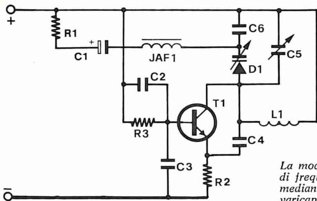
La modulazione di frequenza è ottenuta mediante un diodo varicap.
