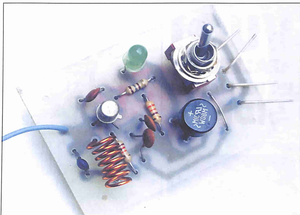
Il prototipo della microspia così come realizzato per i nostri collaudi. Il led serve a segnalare l'entrata in funzione!!
