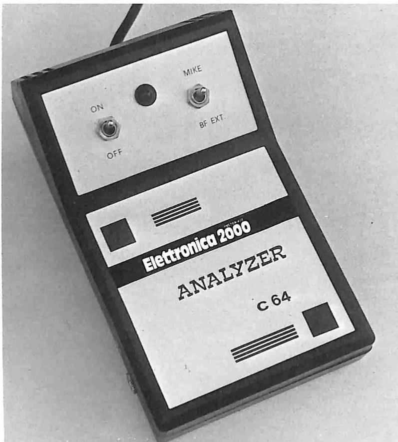
IL PROTOTIPO - L'interfaccia è stata alloggiata all'interno di un piccolo contenitore plastico reperibile presso qualsiasi rivenditore di componenti elettronici. Sul pannello frontale, come si vede nell'immagine, trovano posto i controlli per l'accensione e per la selezione del segnale d'ingresso.
