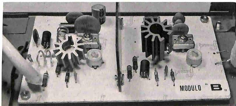
dulo B, pilota. Due transistor T1 (polarizzazione fissa) e T2 (polarizzazione funzione del segnale proveniente da T1). Il segnale proveniente dal modulo A entra attraverso L1 sulla base di T1; raccolto amplificato sul collettore di T1, viene immesso in T2. I componenti C9, C10 e L5 (l'induttanza L5, critica, non è da costruire perché già incisa sulla basetta!) sono i componenti del circuito d'ac-
