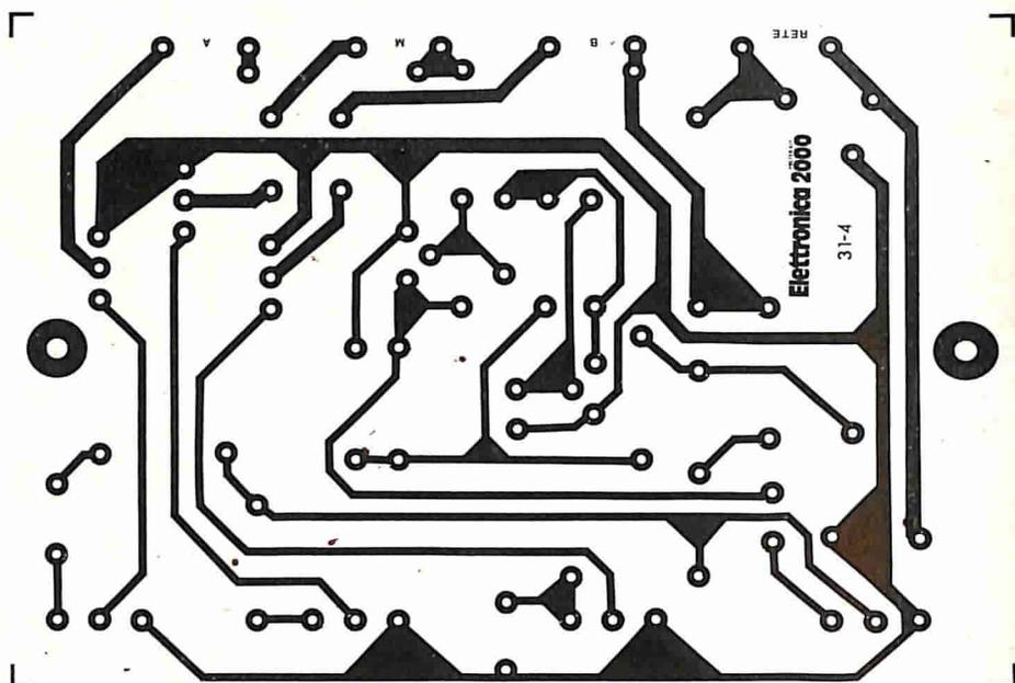
La particolarità più rilevante di questo circuito, oltre l'assenza di fotoaccoppiatori tra lo stadio pilota ed i TRIAC, è nello stadio di alimentazione dell'intero apparecchio, stadio che non utilizza il classico trasformatore-riduttore, bensì un particolare partitore resistivo. Dello stadio alimentatore fanno parte il diodo D1
