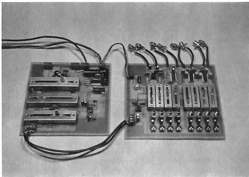
Nell'immagine il prototipo completo del preamplificatore miscelatore. Questo mese vi presentiamo la costruzione della sezione d'ingresso. Il prossimo parleremo del controllo di volume con regolazione di toni e, in seguito, verrà la volta di un finale economico la cui potenza può variare da 25 a 100 watt. Per i collegamenti fra le basette è fondamentale l'uso di cavetti schermati e per evitare ronzii si deve prestare molta attenzione ai collegamenti di massa.
