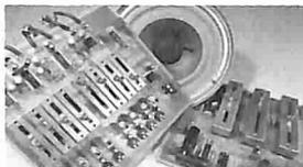
Quattro canali preamplificati con regolazione indipendente del livello e previsti per l'abbinamento ad una scheda master con controllo attivo di toni e a un finale di potenza particolarmente economico.
