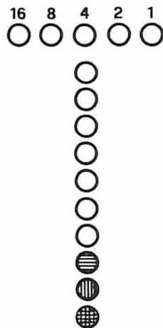
Sul pannello frontale dell'apparecchio è disegnata una struttura a forma di T con un insieme di led. La barra orizzontale in alto rappresenta il punteggio con indicazione binaria: i led valgono pertanto 1, 2, 4, 8 e 16 ed il punteggio massimo è 35. La barra verticale rappresenta il percorso dell'alieno: i diodi led si accendono in sequenza e noi dobbiamo premere il pulsante di sparo solo quando è acceso il decimo led. Ad ogni bersaglio centrato la velocità di discesa degli invasori aumenta.
