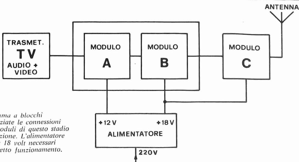
Nel diagramma a blocchi sono evidenziate le connessioni fra i vari moduli di questo stadio di amplificazione. L'alimentatore eroga i 12 e 18 volt necessari per un corretto funzionamento.
