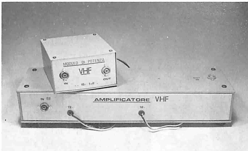
buona volontà. Cominciamo con l'accertarci delle alimentazioni. Pile (tre) del trasmettitore in perfetta carica; il modulatore video deve avere tensione minima 4,5 V; i moduli 2, 3, 4 devono avere tensione non inferiore a 9 V. Controlliamo infine i 12 e i 18 V dell'alimentatore generale. Poi: colleghiamo tutti gli apparecchi tra loro con gli spezzi di cavo da 75 ohm di lunghezza esattamente come descritto in precedenza. Accertarsi che quei semiconduttori det-
