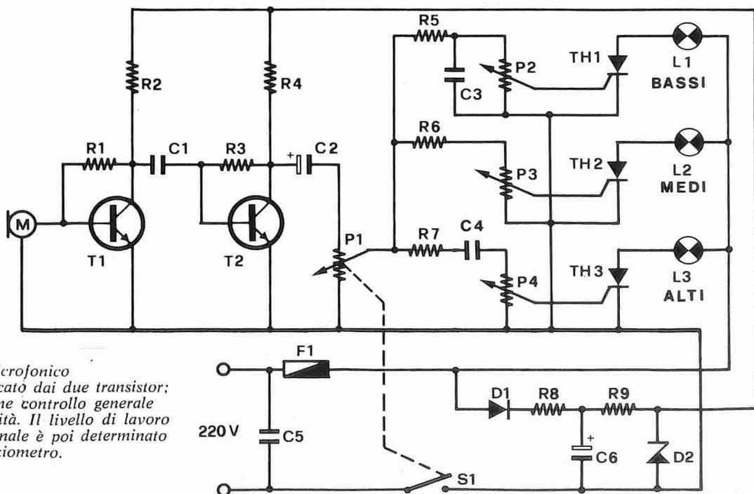
*Il segnale microfonico viene amplificato dai due transistor; P1 opera come controllo generale della sensibilità. Il livello di lavoro di ciascun canale è poi determinato da un potenziometro.*
