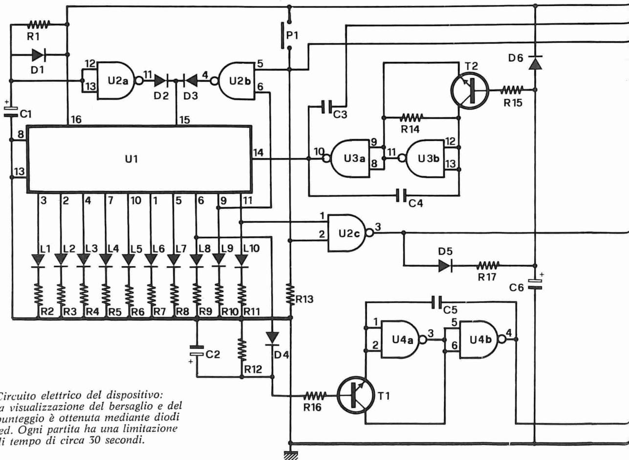
*Circuito elettrico del dispositivo: la visualizzazione del bersaglio e del punteggio è ottenuta mediante diodi led. Ogni partita ha una limitazione di tempo di circa 30 secondi.*
