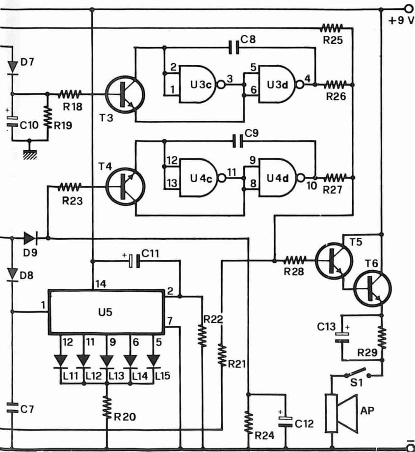
Per poter capire il funzionamento del circuito provvederemo ad una divisione in blocchi: quello per la caduta del led (che interpreta l'alieno), quello per il conteggio dei punti, quello per la generazione degli effetti sonori ed infine quello per l'amplificazione.
