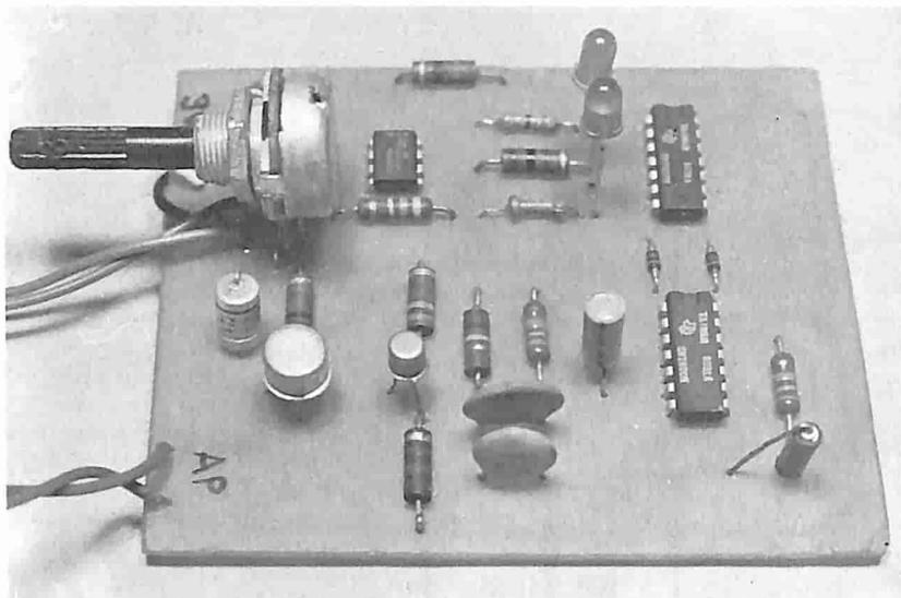
*Ecco come si presenta l'apparecchio con cui abbiamo condotto le nostre sperimentazioni. Gli integrati utilizzati sono di tipo TTL. Effettuando saldature rapide e precise è possibile evitare l'impiego, sempre costoso, degli zoccoli.*
