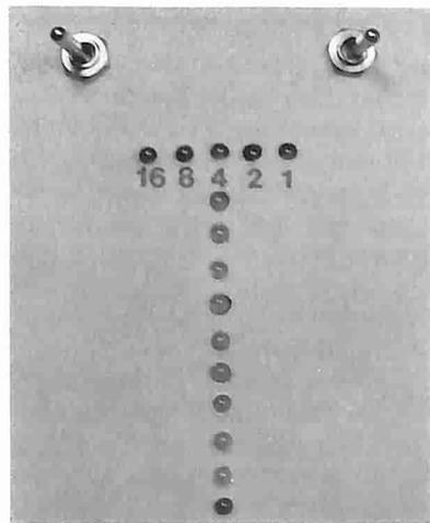
Il contatore è un semplice contatore binario (e non BCD) CD4024 ed il suo clock è ottenuto tramite una porta AND, che viene abilitata dall'accensione del decimo led in concomitanza con la chiusura dell'interruttore di Fuoco. Partendo da destra i cinque led valgono 1, 2, 4, 8 e 16; il massimo punteggio registrabile è quindi di tren-
