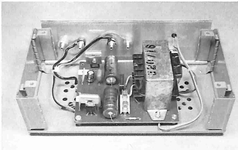
Anche l'alimentatore, per assicurare una buona schermatura rispetto agli altri apparati, è stato racchiuso in un contenitore di metallo. Nelle foto vedete il prototipo aperto e chiuso.
