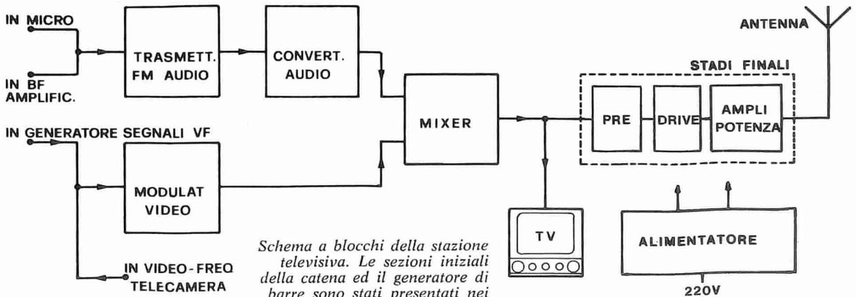
Schema a blocchi della stazione televisiva. Le sezioni iniziali della catena ed il generatore di barre sono stati presentati nei mesi di settembre ed ottobre. Esamineremo qui la sezione di potenza e l'alimentatore.
