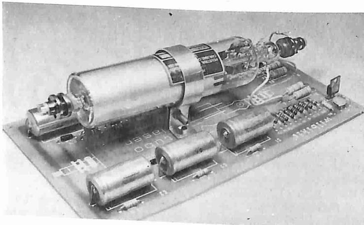
Costruisci un generatore laser da mW di potenza. Una scatola di montaggio per preparare un laser a luce rossa adatta per esperimenti scientifici ed effetti psichedelici. La confezione comprende il circuito stampato inciso e serigrafato; i componenti necessari al montaggio ed il tubo laser da applicare direttamente sulla basetta. Il kit è reperibile presso i distributori dei nostri prodotti oppure direttamente per corrispondenza.
