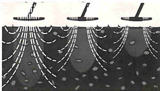
Il sensore del cercametri produce un campo magnetico le cui linee di forza vengono deviate quando incontrano un oggetto metallico. Il fenomeno viene rivelato dallo strumento dell'apparecchio. Il nostro cercametri dispone anche di un segnalatore acustico che produce una nota di bassa frequenza in presenza di oggetti metallici. Nell'immagine, il campo prodotto da tre tipi di cercametri cui corrispondono tre diverse portate (dal manuale Metadec).
