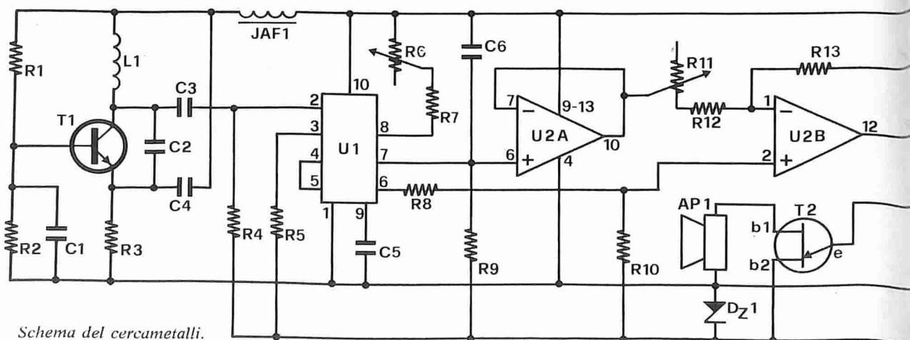
Schema del cercametalli. E' realizzato secondo la tecnica della comparazione PLL ad aggancio di fase.
