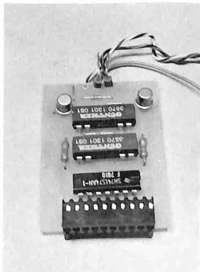
Il modulo che appare nell'immagine, e del quale a lato si vede lo schema, si innesta direttamente alla scheda base dell'Amico 2000.
