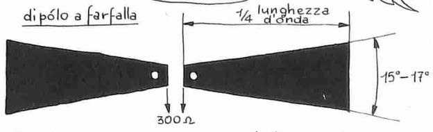
IL DIPOLO A FARFALLA RAPPRESENTA UN'EVOLEUZIONE DEL DIPOLO A CONI. L'ANGOLO DI APERTURA DEL CONO E' DIRETTAMENTE PROPORZIONALE ALL'IMPEDEDENZA DELL'ANTENNA.
