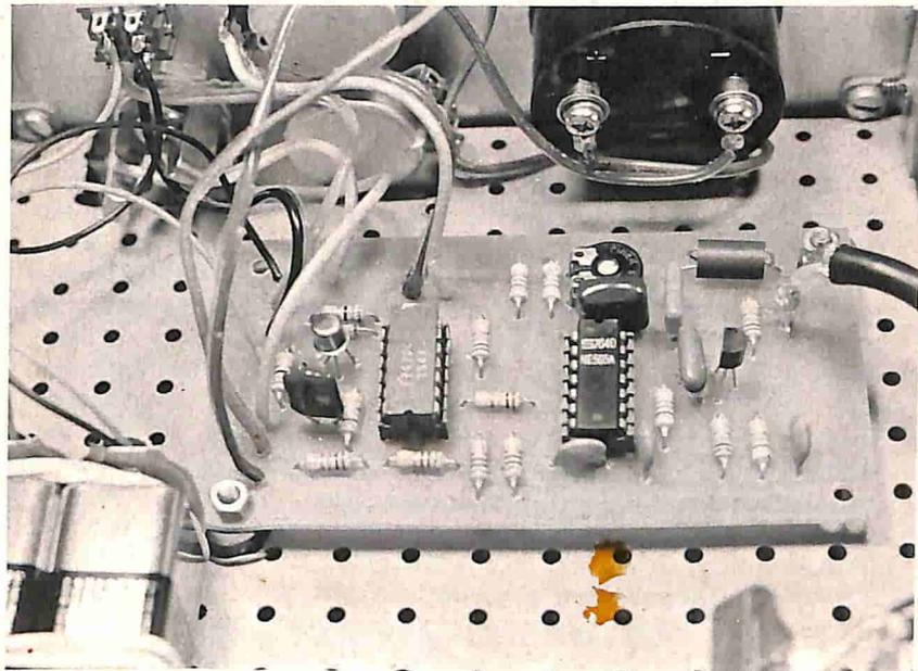
Al pin 12 di U2 è disponibile quindi una tensione che è proporzionale alla variazione di frequenza dell'oscillatore colpitts e va direttamente a pilotare il microamperometro, nel nostro caso uno strumento qualsiasi, grazie alla presenza di U2, compreso tra 20  $\mu$ A e 200  $\mu$ A F.S.
