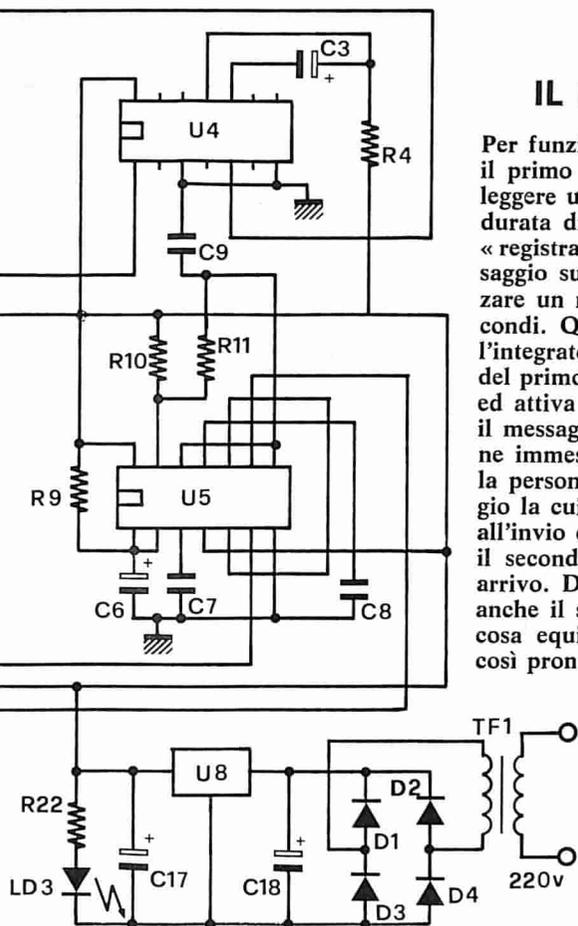
Si veda nell'angolo in basso a destra il dettaglio dello schema elettrico relativo all'alimentatore. Per ottenere una tensione stabile si è utilizzato un regolatore integrato da 5 volt, precisamente il tipo 7805 prodotto dalla National Semiconductor.
