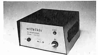
Alimentatore stabilizzato da 12 volt particolarmente idoneo per il funzionamento di radiotelefoni. Circuito a basso livello di ripple ed elevata stabilità anche nelle condizioni di massimo carico (2 ampere). Le dimensioni particolarmente ridotte consentono una facile sistemazione nel laboratorio o nella stazione radio. L'apparecchio è disponibile esclusivamente montato e collaudato.
