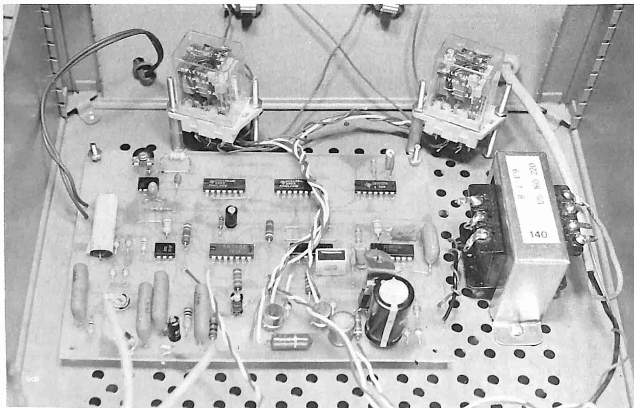
stante si mette in funzione la prima metà di U5, doppio timer disposto in configurazione monostabile; in pratica la sua uscita resta alta per 1,5 secondi permettendo lo sbloccaggio della seconda metà di U5, in configurazione multivibratore astabile.
