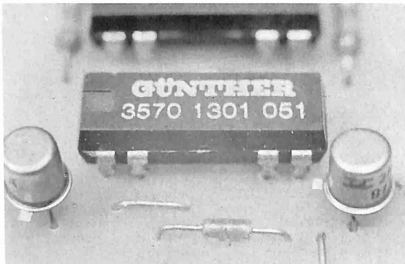
*Uno dei piccolissimi relè ed i transistor per il corretto pilotaggio delle bobine. In primo piano, il diodo di protezione di uno dei transistor.*
