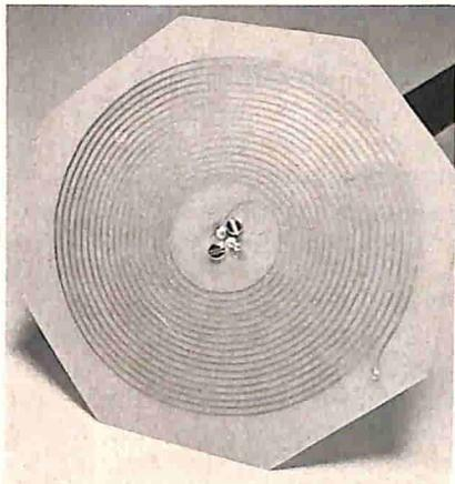
La basetta del sensore dev'essere autocostruita realizzando una struttura analoga a quella che vedete in foto. Il numero di spire non è critico, una ventina sono sufficienti. Per la costruzione si utilizza una piastra ramata.
