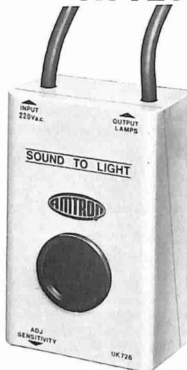
Sistema per la modulazione della luce a mezzo di microfono. Pratico per la realizzazione estemporanea di giochi di luce psichedelici, senza bisogno di complesse installazioni. Circuito estremamente efficiente e di elevata sensibilità. Ingombro minimo.
