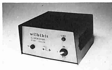
Alimentatore stabilizzato da 12 volt particolarmente idoneo per il funzionamento di radiotelefonii. Circuito a basso livello di ripple ed elevata stabilità anche nelle condizioni di massimo carico (2 ampere). Le dimensioni particolarmente ridotte consentono una facile sistemazione nel laboratorio o nella stazione radio. L'apparecchio è disponibile esclusivamente montato e collaudato.
