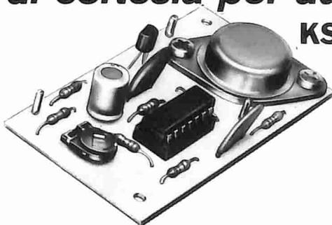
Sistema di ritardo che evita lo spegnimento immediato delle luci di cortesia dell'automobile alla chiusura delle porte. Il tempo è regolabile e permette, per esempio, di inserire la chiave di accensione, o di eseguire qualsiasi altra manovra, senza
