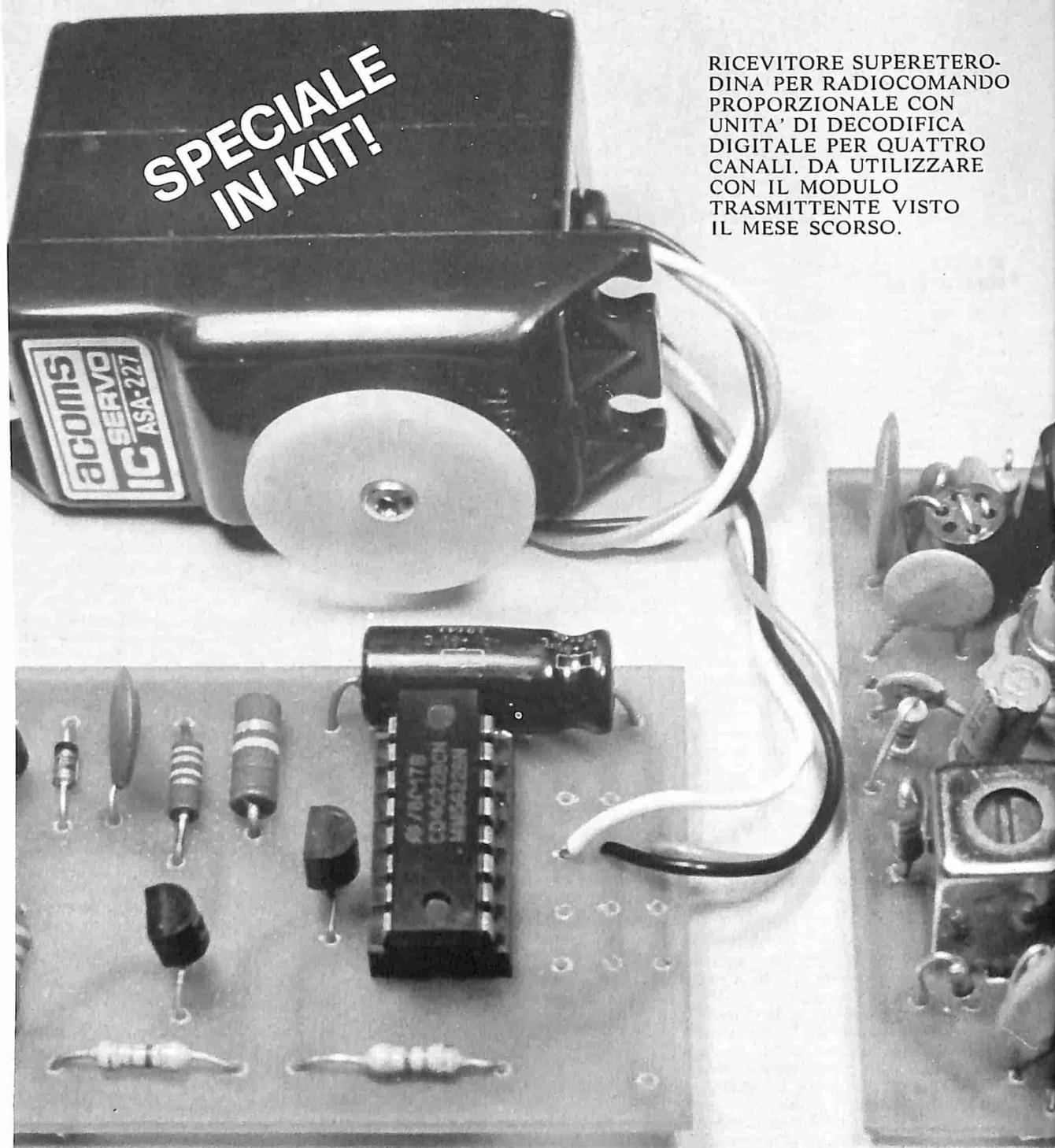
RICEVITORE SUPERETERODINA PER RADIOCOMANDO PROPORZIONALE CON UNITA' DI DECODIFICA DIGITALE PER QUATTRO CANALI. DA UTILIZZARE CON IL MODULO TRASMETTENTE VISTO IL MESE SCORSO.
