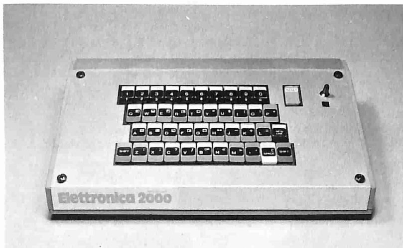
La tastiera, collegata al computer con un flat cable a 20 poli, inserita in una piccola mini consolle Ganzerli. Al prossimo mese la nuova sistemazione del circuito del computer stesso, del suo monitor e di un comodo lettore per cassette: in pratica lo ZX80 diventa un vero e proprio personal.
