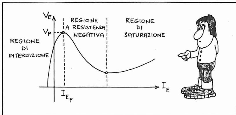
punto oltre il quale il dispositivo si comporta come un normale diodo a giunzione. La curva caratteristica illustra il tipico andamento della tensione di emittore in funzione della relativa corrente.
