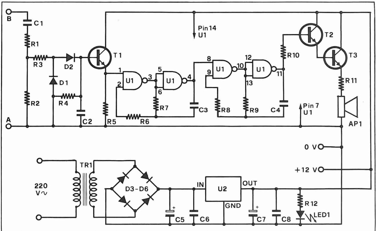
*Schema elettrico dell'alimentatore e della suoneria elettronica. Quest'ultima utilizza un CMOS per avere un forte segnale bitonale.*
