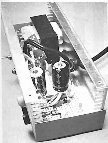
*Prototipo dell'apparecchio, costruito ancora con bassetta perforata, e successive soluzioni: a sinistra, bassetta stampata e, a destra, il contenitore con i comandi e le prese d'uscita.*
