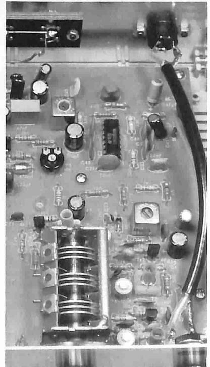
*Particolare della sezione di alta frequenza: il variabile demoltiplicato.*
