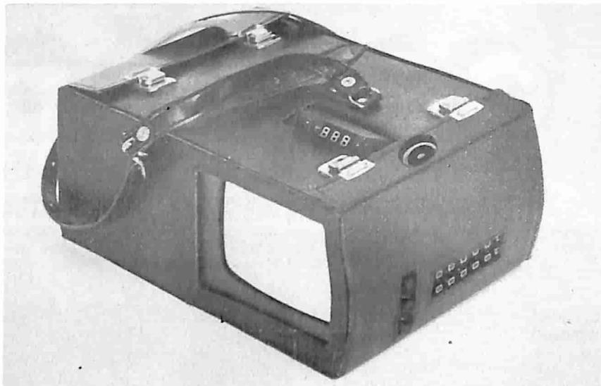
Misuratore di campo con monitor TV ed analizzatore di spettro mod. 1001. L'apparecchio è in grado di funzionare da 48 a 82 MHz; da 175 a 250 MHz e da 470 a 900 MHz. Per informazioni contattare: La Commerciale FM Jolly, via Butinone 19, Caravaggio (BG).
