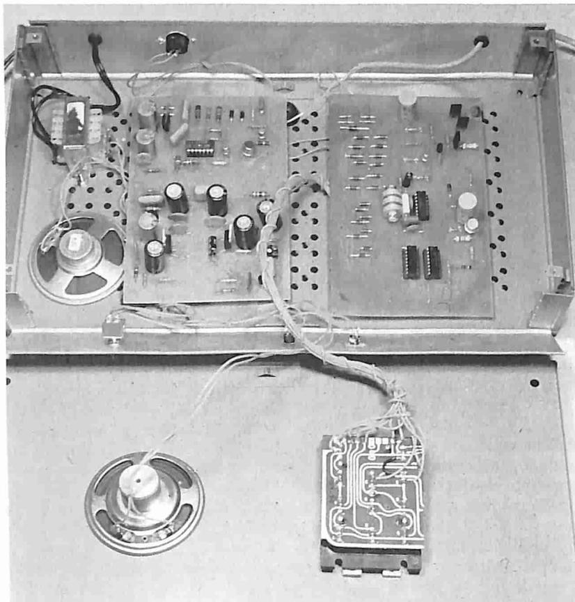
*Il telefono è stato inserito in un contenitore metallico della Ganzerli. A sinistra, disposizione delle basette all'interno e relativi collegamenti; in basso, l'apparecchio ultimato.*
