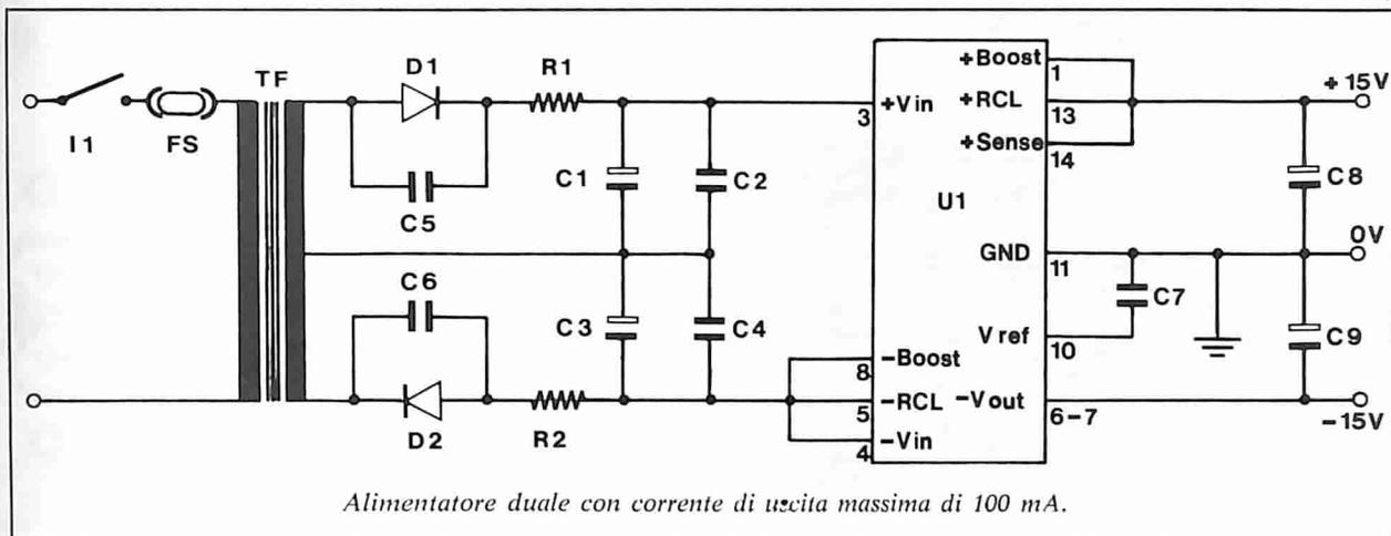
secondaria e la potenza erogate, sono da tenere presenti alcune considerazioni. L'elettrolitico di filtro tende a caricarsi ad un potenziale pari a quello di picco della tensione fornita dal secondario il quale è pari al valore efficace della tensione secondaria moltiplicato per 1,41 ( $\sqrt{2}$ ).
