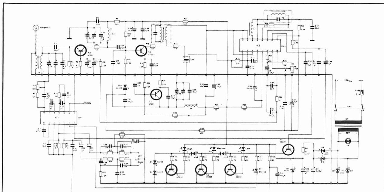
*Schema elettrico del ricevitore FM. La fedeltà è buona: la risposta in frequenza, misurata nell'escursione fra  $\pm 1$  dB, stabilisce che i suoni riprodotti spaziano fra 30 e 12.000 Hz. La sensibilità d'ingresso dell'rx corrisponde a 2,5  $\mu$ V e la separazione stereo vale 30 dB. L'apparecchio è disponibile presso le sedi GBC come kit (cat. SM 1543-05) o montato e collaudato (cat. SM 1543-07).*
