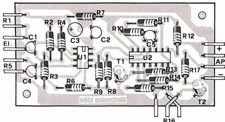
Preparazione della bassetta e disposizione di tutti i componenti.
