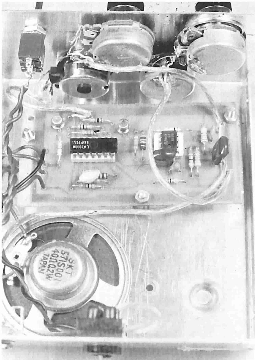
*Il cablaggio del contenitore. L'alimentazione può essere esterna ma è possibile anche preparare un circuito da inserire all'interno avendo cura di schermare per evitare ronzii.*
